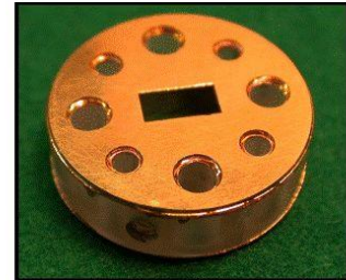
Etwa 6 mm dick, aus ABS-Kunststoff In der Mitte das Loch für den Hohlleiter
