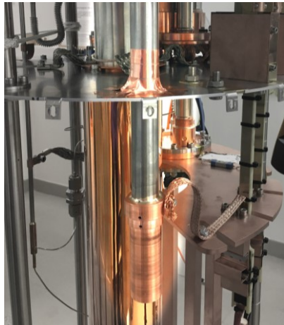
Kleinkühler für den kombinierten Betrieb von QHR und Josephson Spannungsnormal
