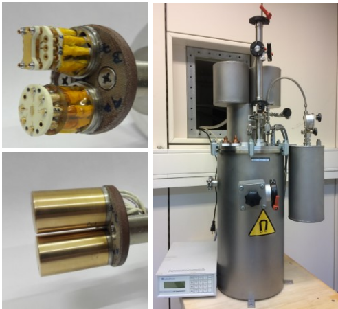
Probenhalter für zwei QHR in LHe in einem 7 T Magnet (links). Trockener Kleinkühler mit 5 T Magnet (rechts)
