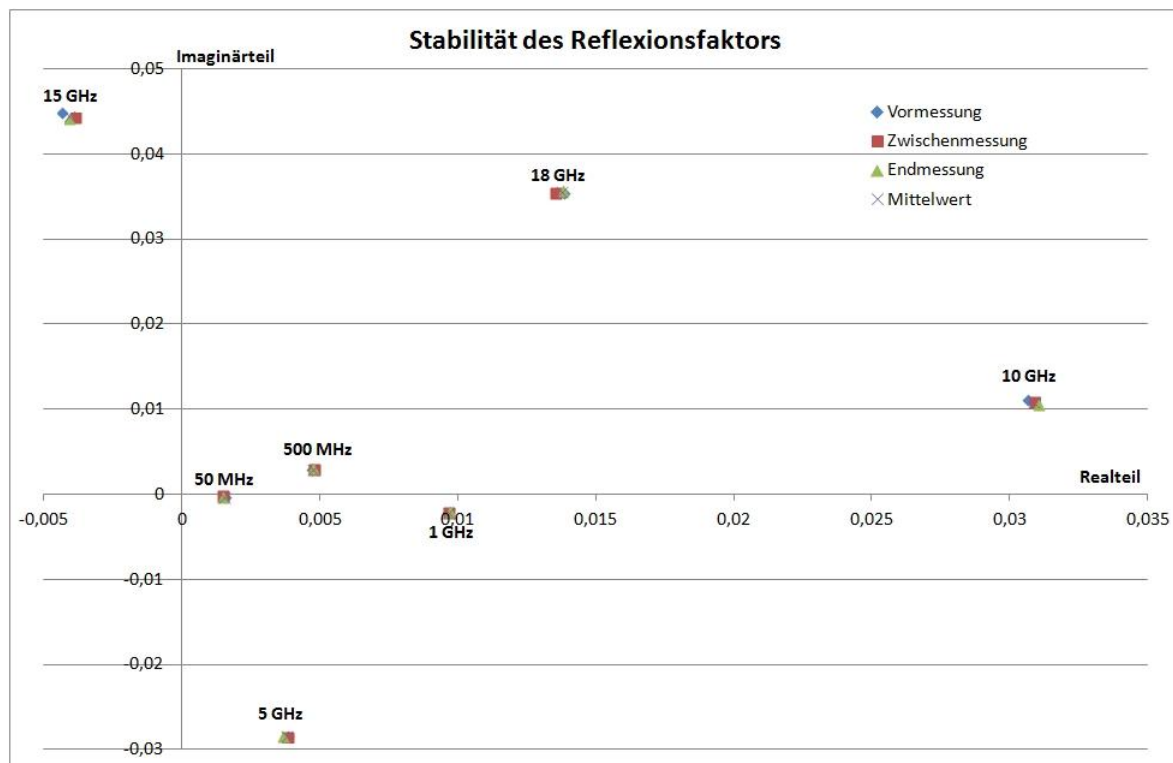
Abbildung 7.2.3: Stabilität des Reflexionsfaktors in der komplexen Ebene
