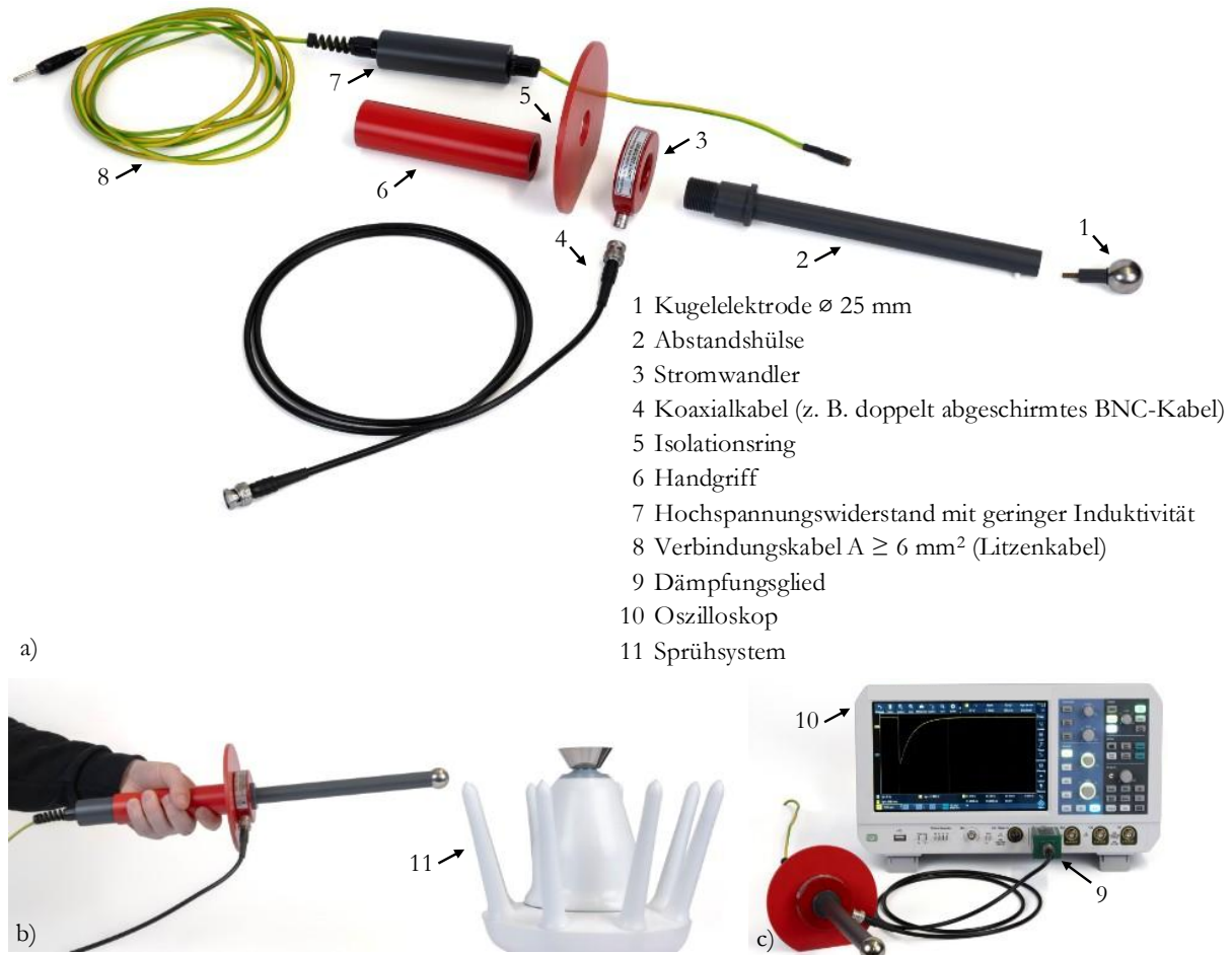
Abbildung 6: a) demontierte Messtechnik mit Stromwandler, b) Messtechnik in der Anwendung an Sprühsystem, c) Messtechnik über Dämpfungsglied mit Oszilloskop verbunden
