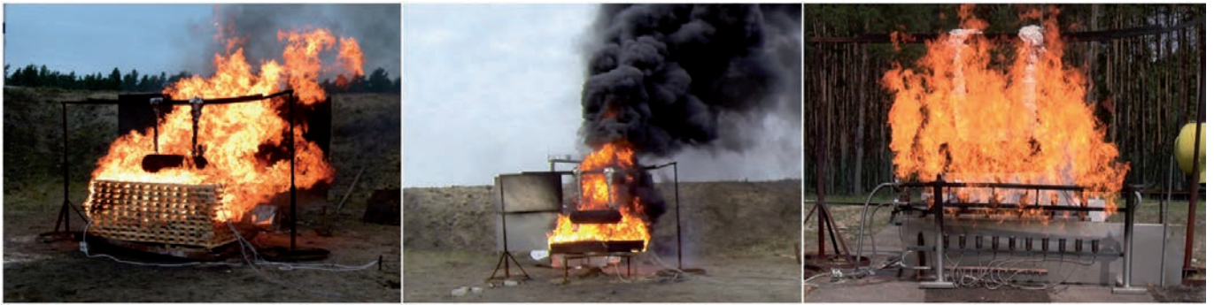
Bild 1: Quantifizierung verschiedener Unterfeuerungsverfahren, Holzfeuer (links), Benzinpoolfeuer (mittig), Gasfeuer (rechts), je mittig hängend im Feuer der wasserdurchströmte Flaschendummy
