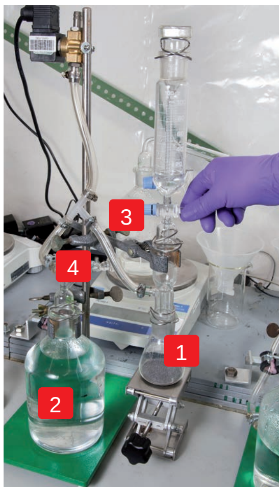
Bild 1: Foto der in der BAM verwendeten gravimetrischen Prüfapparatur zur Bestimmung der Gasentwicklungsra- te für den Versuch gemäß Kapitel 33.4.1.4.3.5 der Prüfmethode UN Test N.5 (Quelle, Foto: BAM)
