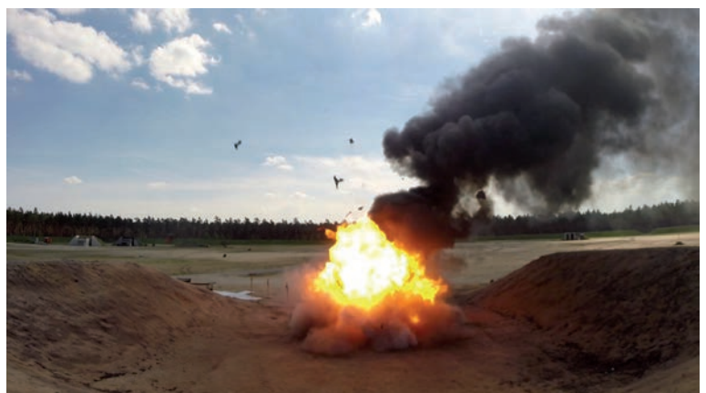
Bild 5: Fragmentierung direkt nach Behälterversagen, Radmuldentank, Füllgrad 20 %
