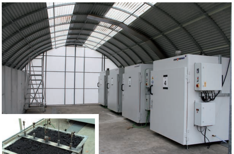
Bild 2: Wetterschutztunnel mit 4 Versuchsöfen (Wärmekammern)
