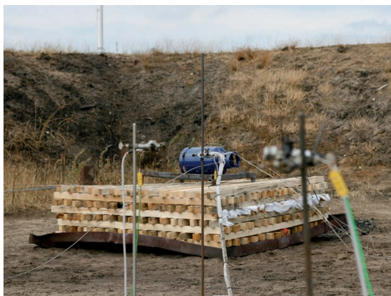
Bild 3: Genereller Aufbau der Unterfeuerungsversuche, im Hintergrund eine 11-kg-Propangasflasche mit einem vorbereiteten Holzfeuer (Versuchsserie 1, vgl. Tabelle 2), im Vordergrund 3 Stative mit Druck- und Temperatursensoren für die Messung der Wirkung des Behälterversagens auf die Umgebung
