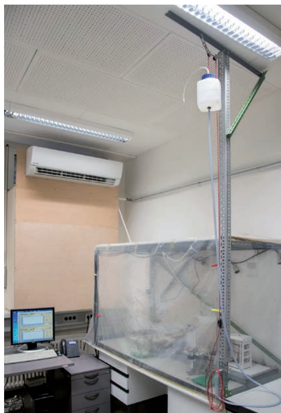
Bild 3: Gesamtansicht der im klimatisierten Laborraum in der zusätzlichen Klimaeinhausung befindlichen Prüfapparat gemäß UN Test N.5 sowie der Verifizierungsapparat und dem zur Generierung eines konstanten Wasservorrucks unter der Raumdecke (rechts oben im Bild) aufgehängten Wasservorratsbehälter, der per Schlauch mit dem Rotameter verbunden ist (Quelle, Foto: BAM)
