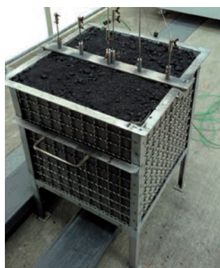
Bild 3: Instrumentierter Pro- benbehälter (125 dm 3 ) mit Koksprobe
