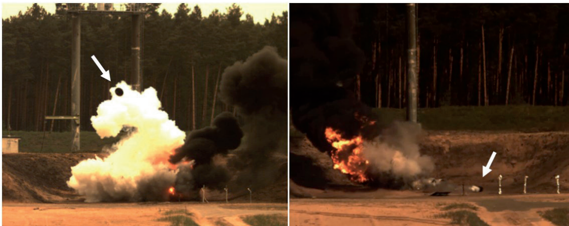
Bild 6: "Rocketing" von Fragmenten, Rad- muldentanks, FG 100 %, an- getrieben durch verdampfendes und freigesetztes Flüssiggas
