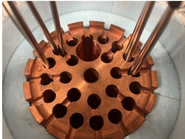
Abbildung 4.9: Kupferblock mit Bohrungen in denen Temperaturmessspitzen platziert sind.
