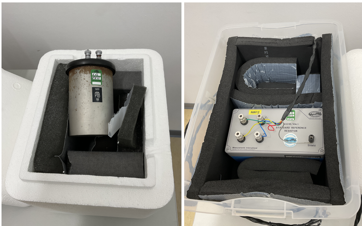
Abbildung 4.19: Referenzwiderstände in ihren provisorischen Abschirmungen.
