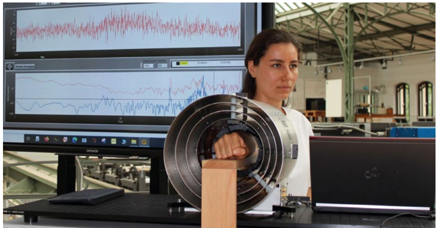
Eine Testperson hat einen Arm in einem mobilen Magnetomyografie-System mit Abschirmung positioniert. Ein optisch gepumptes Magnetometer (OPM) erfasst die Muskelaktivität, deren magnetische Signalstärke auf dem Monitor dargestellt wird. Die Abschirmung reduziert äußere magnetische Störungen und ermöglicht eine präzise Signalaufnahme. (Foto: research-in-germany.org)
