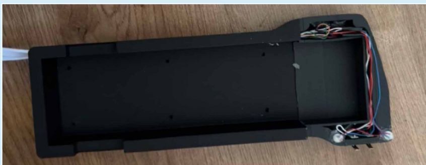
Abb. 7: Innenansicht des Griffs mit Kabelkanal
