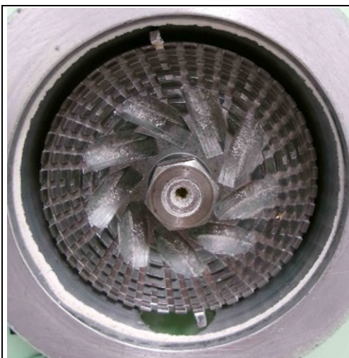
Abbildung 15: Weizen - Mahlwerk Mühle WB31
