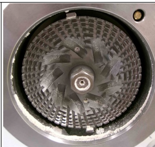
Abbildung 16: Weizen - Mahlwerk Mühle LM3310
