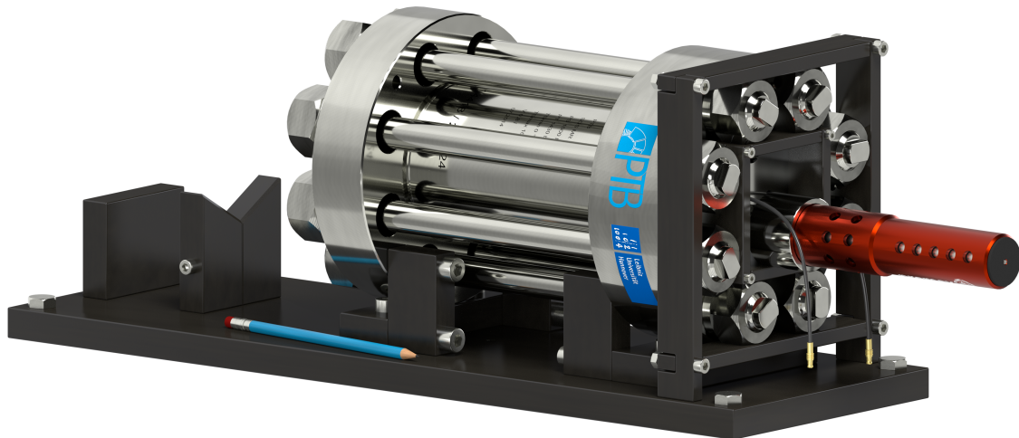
Abbildung 4.8: Druckmesszelle auf Montagevorrichtung
