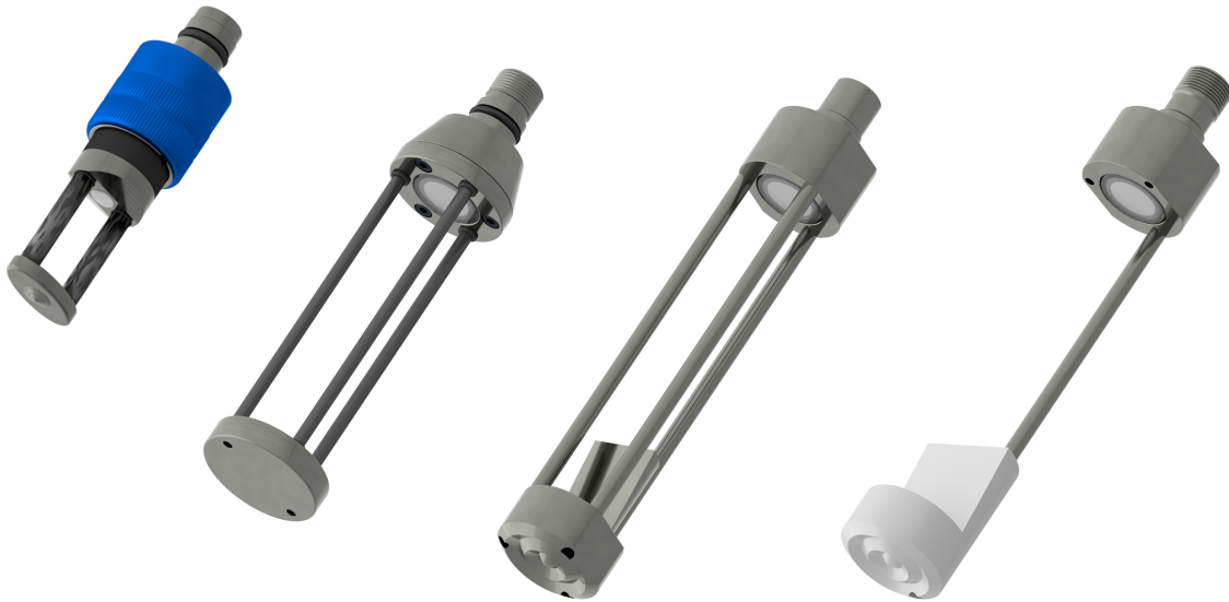
Abbildung 4.3: Schallgeschwindigkeitssensoren: AML Oceanographic SV Xchange OEM, Valeport miniSVS 100 OEM und Eigenentwicklungen mit innovativen Doppelreflektoren (von links, Maßstab 1:2)
