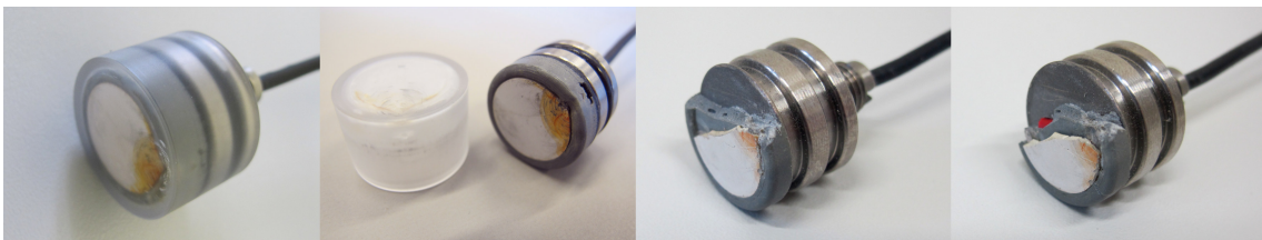
Abbildung 5.24: Demontage eines beschädigten Sensorkopfes
