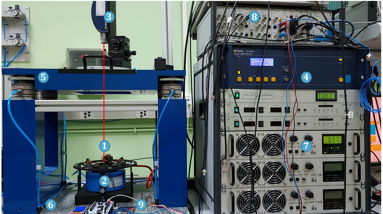
Abbildung 6.7: Beschleunigungskalibriersystem Spektra CS-18 am CEM mit DAU und Sensor. Das System besteht aus folgenden Komponenten: ① MEMS-Sensor auf Aluminiumblock, ② luftgelagerter Schwingerreger Spektra SE-09, ③ LDV-Kopf Polytec CLV-2534 mit ④ Controller, ⑤ Schwingungsisolierung, ⑥ Granitbasisplatte, ⑦ Leistungsverstärker, ⑧ Steuerungseinheit und ⑨ DAU für digitale Sensoren.
