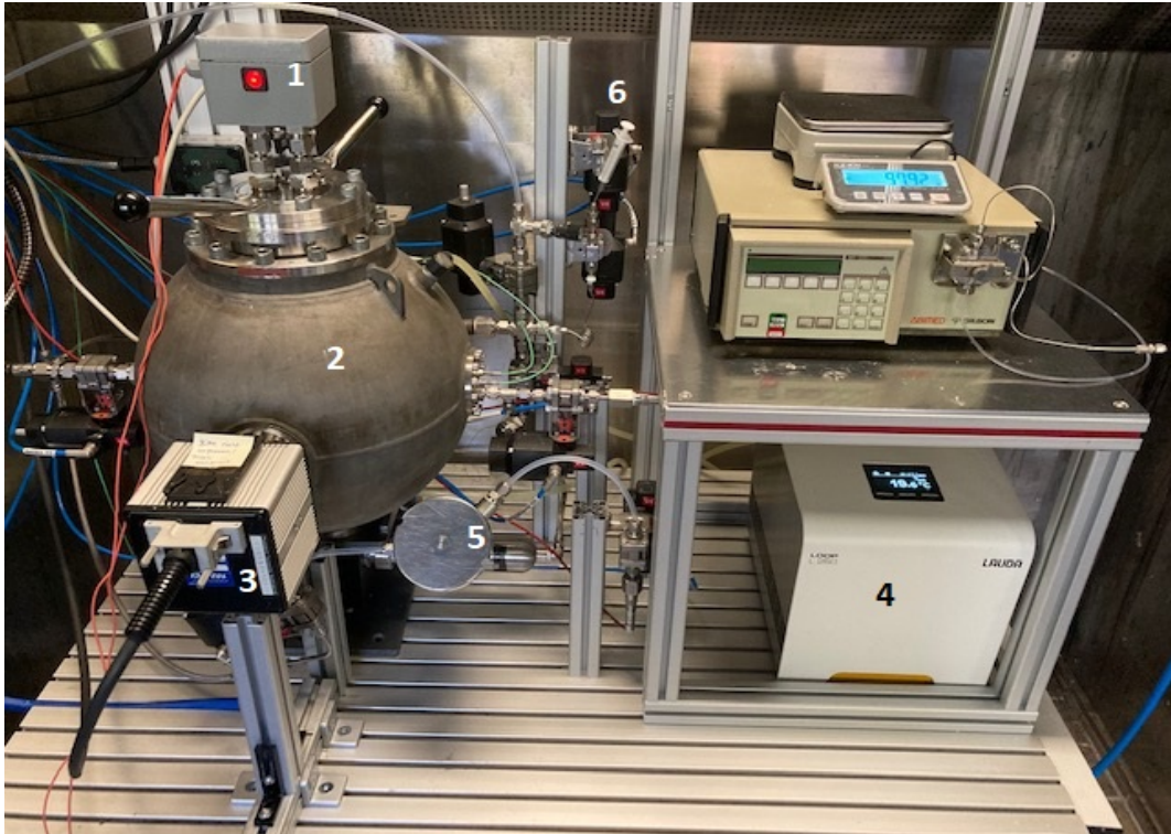
Abbildung 3.10.: Versuchsaufbau zur Visualisierung der Strömungszustände (1 Lichtquelle, 2 20-l-Kugel, 3 Kamera, 4 Kryostat, 5 Staubbehälter, 6 Spritze)
