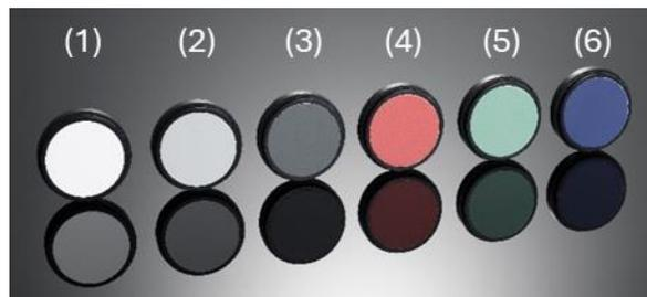
**Abbildung 28:** Satz käuflich erhältlicher matter Keramikproben. Die im Rahmen dieser Arbeit untersuchten Proben sind: Die weiße (1), die rote (4) und die blaue (6) Probe [12].
