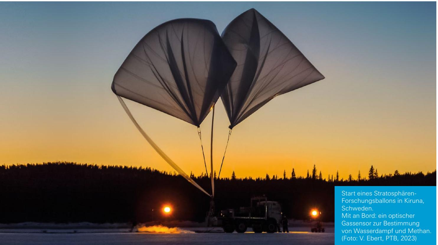
Start eines Stratosphären-Forschungsballons in Kiruna, Schweden. Mit an Bord: ein optischer Gassensor zur Bestimmung von Wasserdampf und Methan. (Foto: V. Ebert, PTB, 2023)
