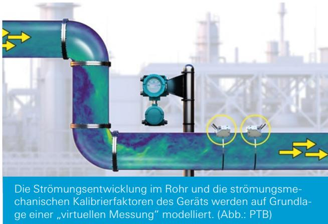
Die Strömungsentwicklung im Rohr und die strömungsmechanischen Kalibrierfaktoren des Geräts werden auf Grundlage einer „virtuellen Messung“ modelliert. (Abb.: PTB)
