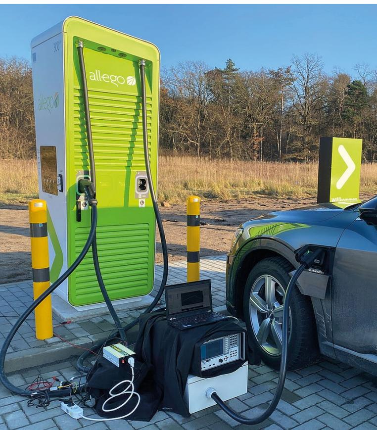
Ladevorgang eines Elektrofahrzeugs an einer Schnellladesäule mit zwischengeschaltetem Messsystem
