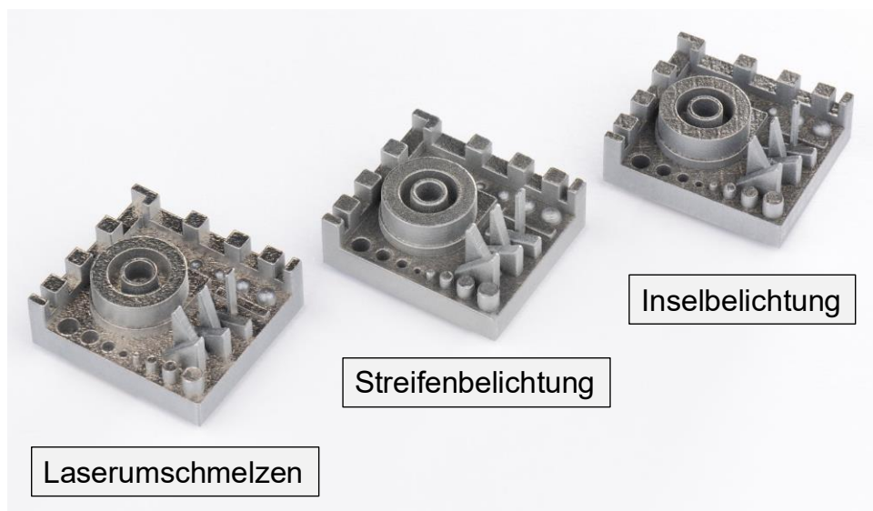
Abb. 49: Prüfkörper mit verschiedenen Belichtungsstrategien: Laserumschmelzen, Streifenbelichtung (Einzelbelichtung) und Inselbelichtung (Einzelbelichtung)
