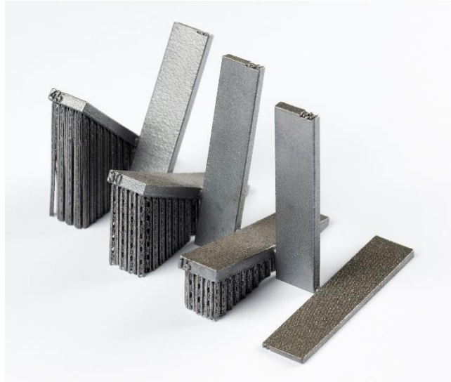
Abb. 2: Schräge Oberflächenstrukturen aus AlSi10Mg mit ( \delta \leq 45^\circ ) und ohne ( \delta > 45^\circ ) Stützstrukturen
