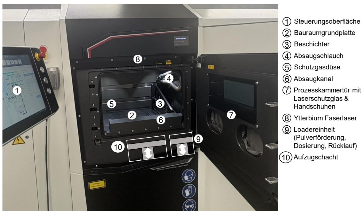
Abb. 10: Aufbau und Hauptkomponenten einer PBF/LB-M-Anlage
