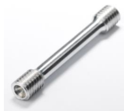
Abb. 12: Grundkörper der Zugproben mit verschiedenen Bauorientierungen (a) und fertig bearbeitete Zugprobe gemäß DIN 50125 - Form B (b)
