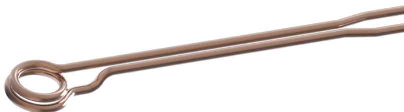
**Abb. 5.1: Induktionsheizer** Die Form der Spule aus sauerstofffreiem Kupferrohr wurde so gewählt, dass sie möglichst dicht an der Probe verläuft und Zuleitungen stets nahe beieinander liegen, um Leistungsverluste zu vermeiden und eine gute Probenerwärmung zu gewährleisten.
