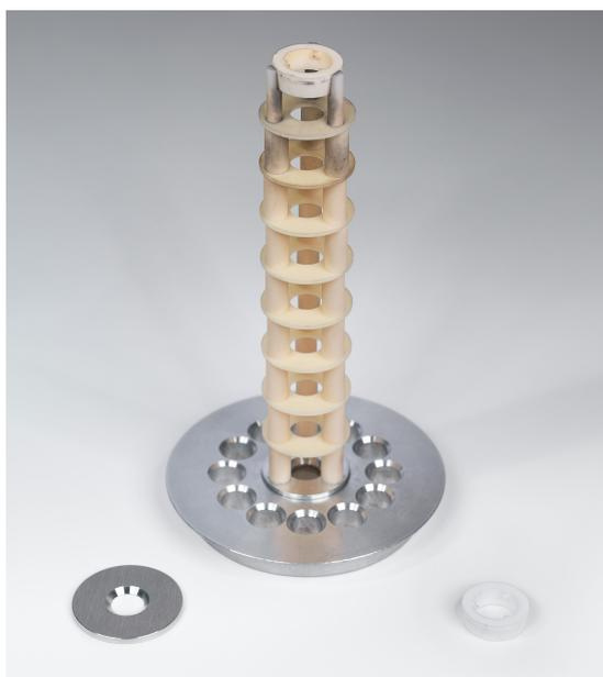
**Abb. 5.10: Al<sub>2</sub>O<sub>3</sub>-Probenhalter** Der Probenhalter ist aus hochreinem Al<sub>2</sub>O<sub>3</sub> gefertigt und daher besonders reaktionsarm. Die Probenaufnahme ist über drei Stützen mit der Basis verbunden, an der eine Blende zur Laserstrahlformung sitzt. Die Ringe oberhalb der Blende unterstützen die Strahlformung und dienen außerdem als Kühlrippen.
