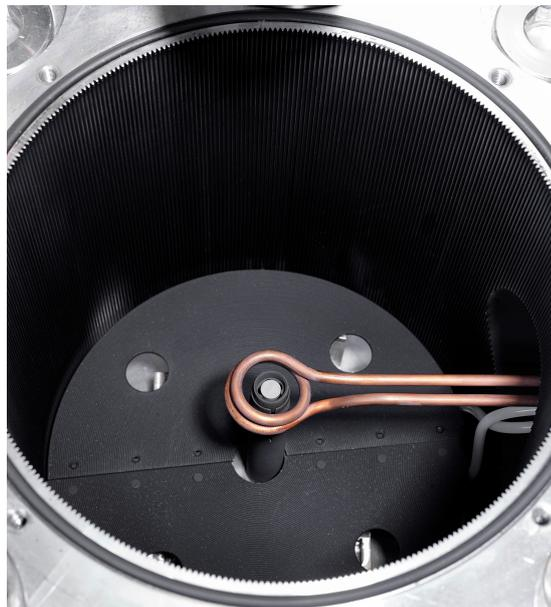
**Abb. 5.8: Innenraum der Probenkammer** Die Innenwände der Probenkammer sind mit einer V-förmigen Nutenstruktur versehen. Um die Absorption von Strahlung innerhalb der Kammer zu erhöhen, wurden zusätzlich eine Beschichtung aus NEXTEL Velvet Coating 811-21 aufgetragen.
