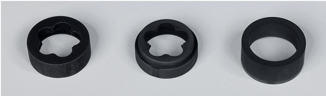
**Abb. 5.12: Probenaufnahme und Suszeptor** Das Design der Probenaufnahme (links) wurde angepasst, um sie mit den Geräten in der Feinwerkstatt des Fachbereiches zu fertigen. Der Suszeptor (rechts) kann auf eine angepasste Probenaufnahme über eine Überblattung aufgesetzt und zentriert werden.
