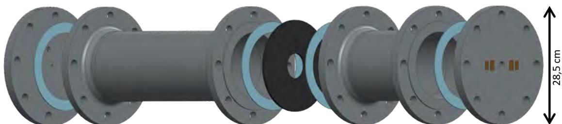
Abb. 3.2.: Zylindrisches Zweikammersystem
