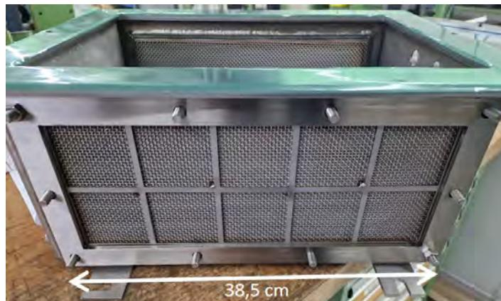
Abb. 3.5.: Druckfeste Kapselung vom Typ 8280 [67]
