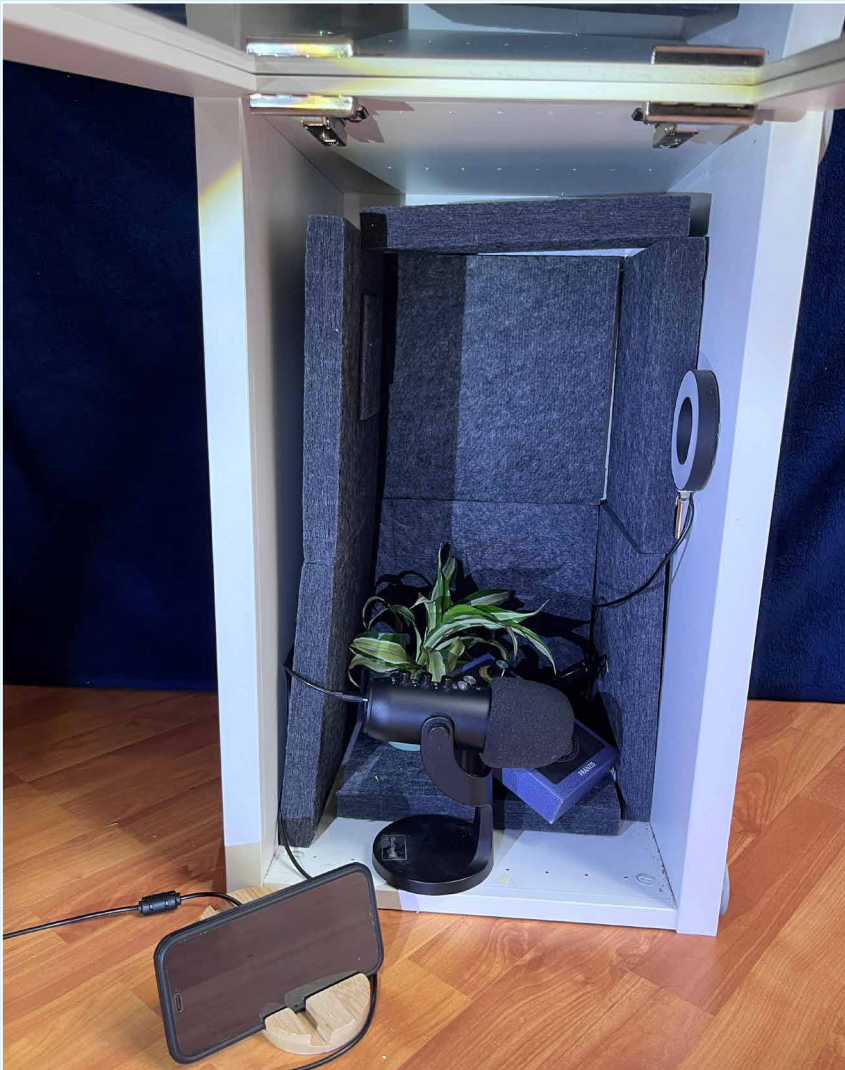
Abb.1: Die Akustikbox mit Pflanze und Messgeräten
