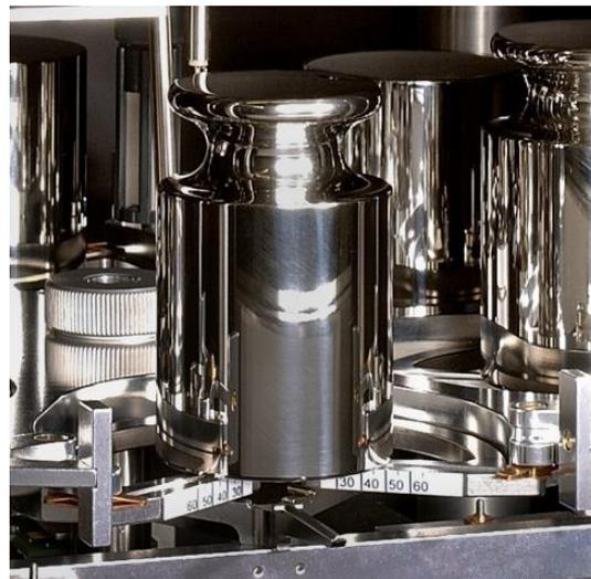
Abbildung 1-2 Innenansicht in den Messraum und Position eines Massestücks auf Auflagepunkten im Massekomparator M\_one
