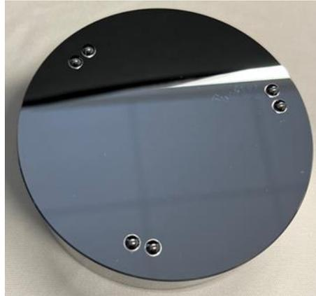
Abbildung 6-6 Eingelassene Kupplungskugeln und sichtbare Indiumringflächen, Grundscheibe des gefertigten Sorptionskörpers (3-Scheibenkörper)
