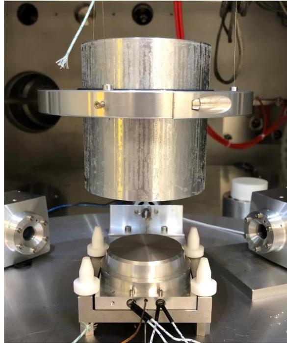
Abbildung 6-10 Aufbau zur Montage von Hohlzylinder und Deckel in einer Hochvakuumkammer. Zu sehen ist der aufgehängte Hohlzylinder über dem auf einer Heizplatte positionierten Deckel
