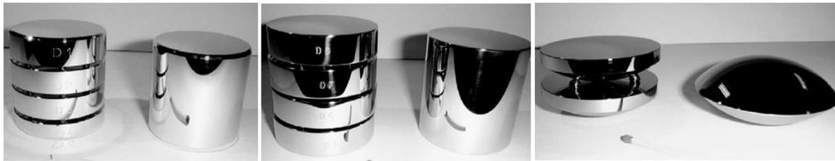
Abbildung 1-5 Transferkörper für die Untersuchung zu Sorptionseffekten bestehend aus unterschiedlichen Materialien: Platin-Iridium (links), Edelstahl (mittig) und Silizium (rechts)
