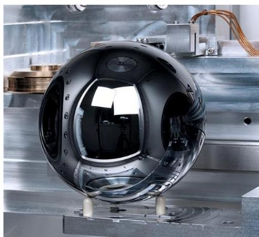
Abbildung 1-1 Siliziumkugel auf Pistons im Massekomparator Sartorius CCL1007
