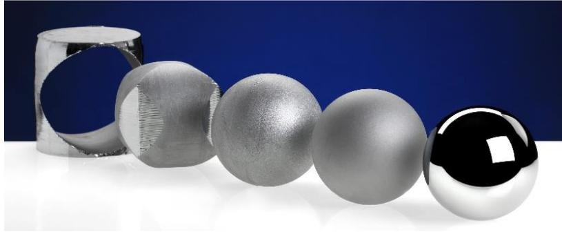
Abbildung 6-1 Mehrstufige Prozesskette zur Herstellung einer Kugel. Von links nach rechts: Schneiden, Drehen, Läppen, Polieren. Modifiziert [Meeß15]
