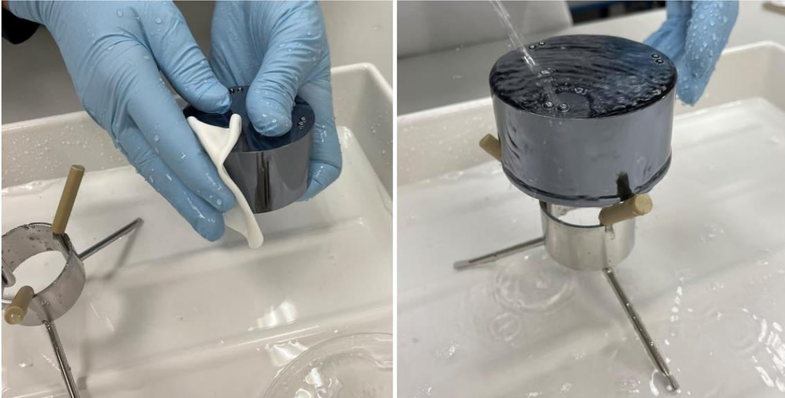
Abbildung 6-11 Praktische Überprüfung der Reinigungsmethode mit gefertigtem 2-Scheibenkörper. Links: Reinigung mit speziellem Tuch getränkt mit Reinigungslösung, rechts: Überspülen der auf einem Dreibein gelagerten Grundscheibe des 2-Scheibenkörpers mit destilliertem Wasser
