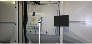
**Abbildung 14:** Ammonit-Windkanal in Bargeshagen (links); Kalibrierung des Flügelradanemometers in der Messkammer (rechts)
