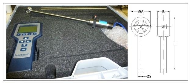
**Abbildung 1:** Flügelradanemometer mit Handgerät, Sensorkopf-Durchmesser ( $\emptyset$ A = 26 mm), Sensorkopf-Länge (B = 26 mm) und Sensorlänge (gesamt) L = 350 mm, Schaftdurchmesser 8/25 mm mit Gewinde zum Anschrauben von Verlängerungsstangen  $\emptyset$  25 mm
