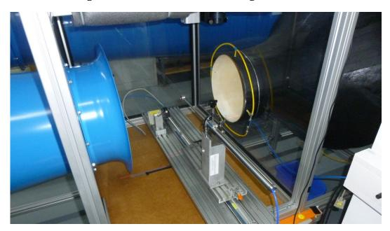
**Abbildung 6:** Flügelradanemometer in der Messkammer des Höntzsch-Windkanals. Das LDA befindet sich oben rechts.
