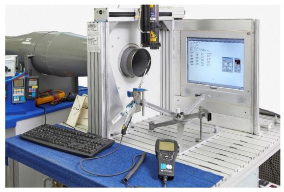
**Abbildung 9:** Flügelradanemometer in der Airflow-Messkammer. Das LDA ist oben in der Mitte fixiert.
