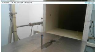
**Abbildung 15:** Messanordnung des DWG-Windkanals WT2
