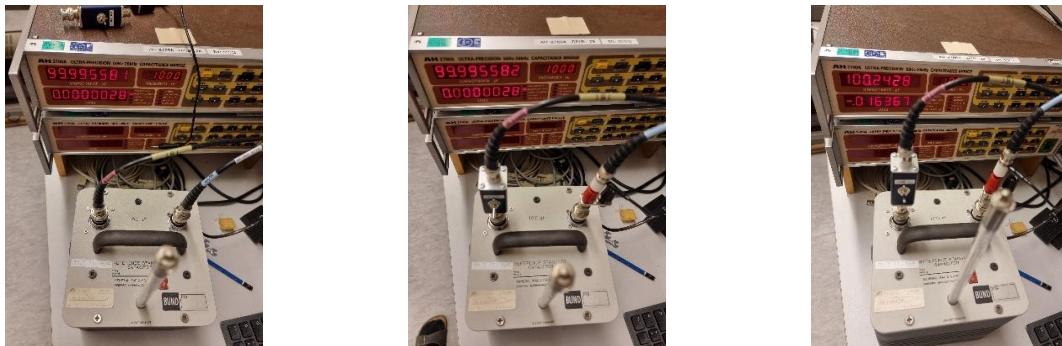
Abb. 11 .. 13: Referenzmessung GR1404-B-2933 in dreipoliger Anschlussweise, mit Adapter zur Vergleichsmessung R_F \approx 0\ \Omega und mit zugeschaltetem Außenleiterwiderstand R_F = 200\ \text{k}\Omega .
