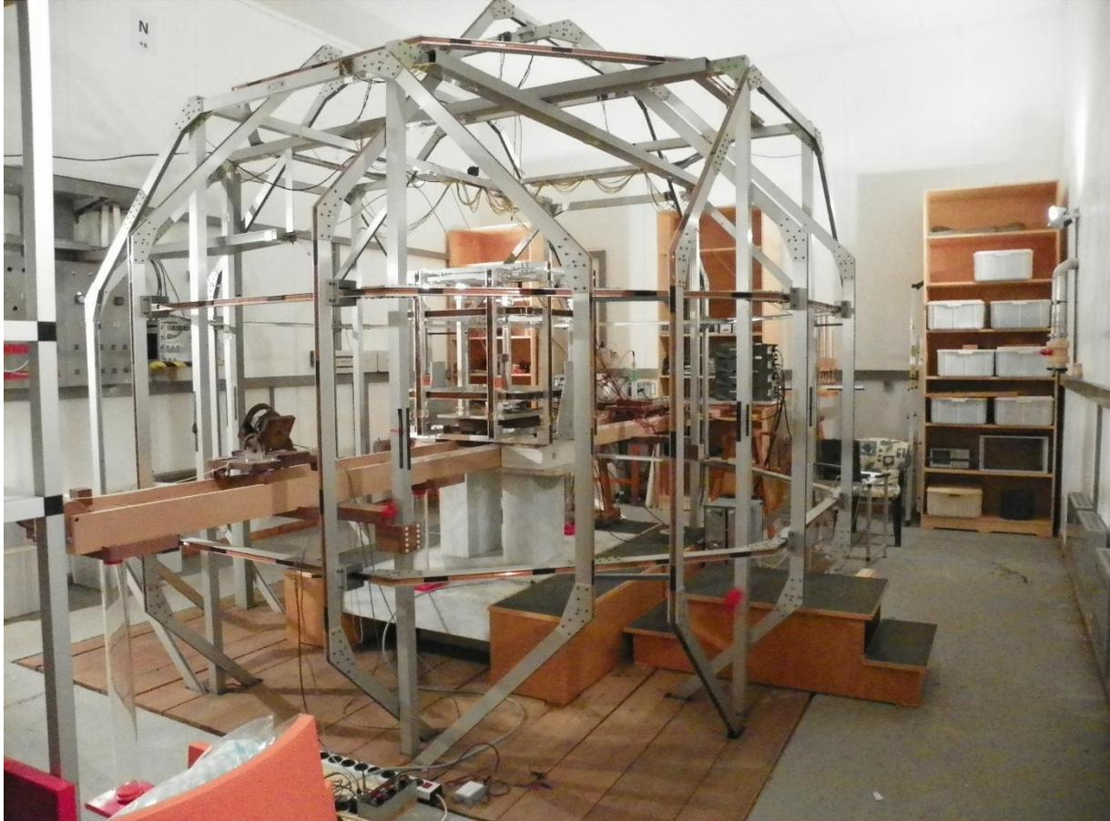
Abb. 16: Dreiaxsiges Spulensystem nach Braunbek zur Kompensation der drei Raumkomponenten des Erdmagnetfeldes
