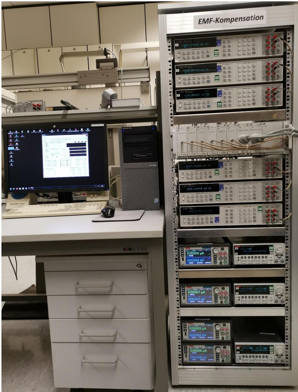
Abb. 17: Aufbau der EMF-Kompensationsanlage
