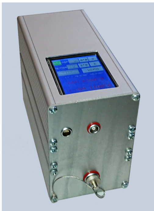
Abb. 4: Foto des fertig aufgebauten Puls-Elektrometer-Verstärkers mit den Buchsen für Ionisationskammerstrom, Kammerspannung und Temperaturfühler
