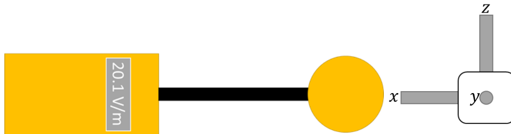
Schematische Darstellung der unterschiedlichen Feldsonden-Bauformen
