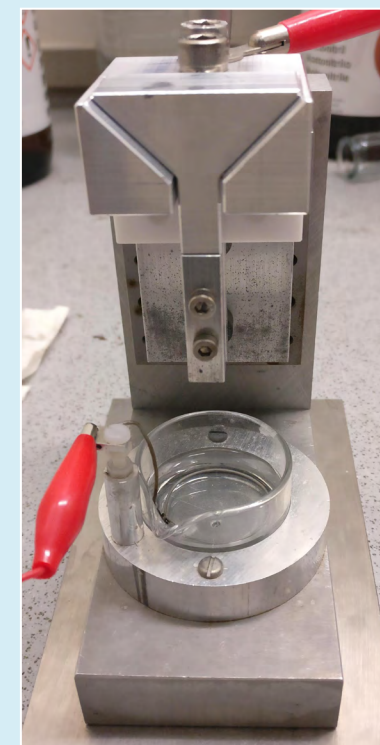
Abb. 5: Spitzenätzvorrichtung der LMU in Garching
