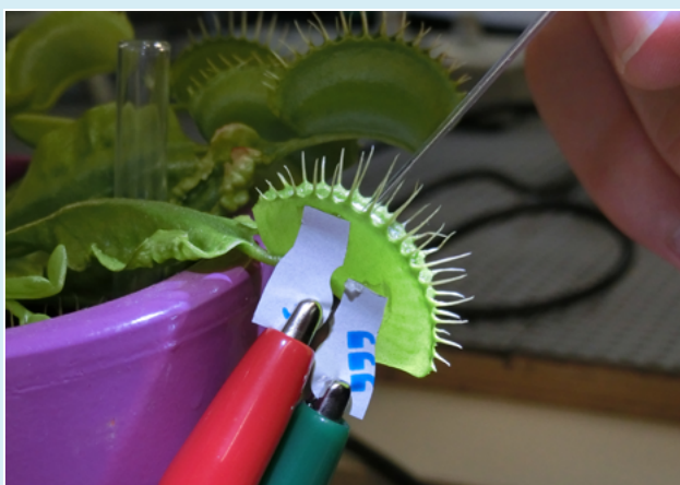
Abb. 7: EKG-Klebeelektroden und deren Anschluss an den EKG-Sensor
