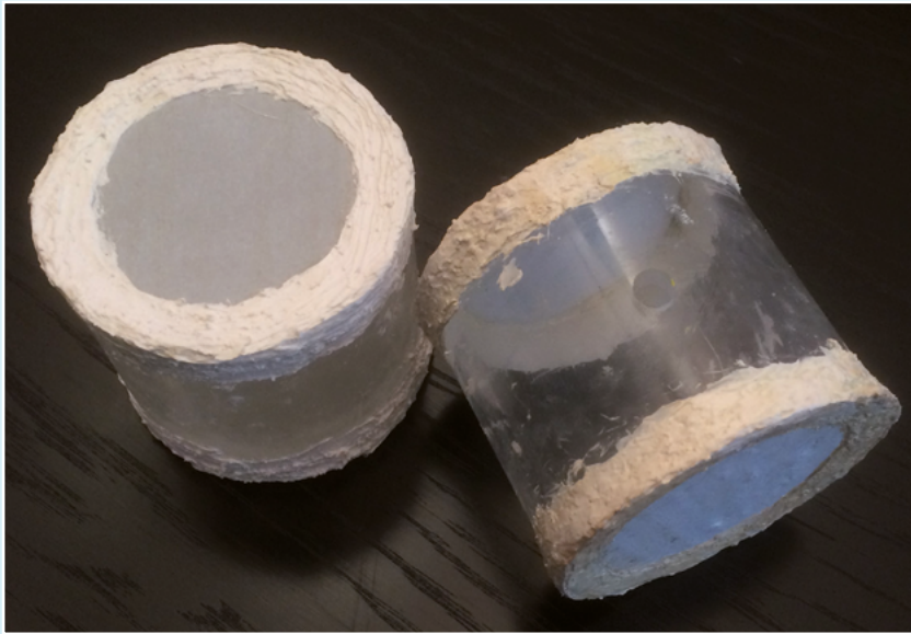
Abb. 1: Zwei Filtervorrichtungen. Bei der rechten Vorrichtung ist die 5-mm-Öffnung zu erkennen. Durch diese werden die Vorrichtungen mit Algen und Medium befüllt.
