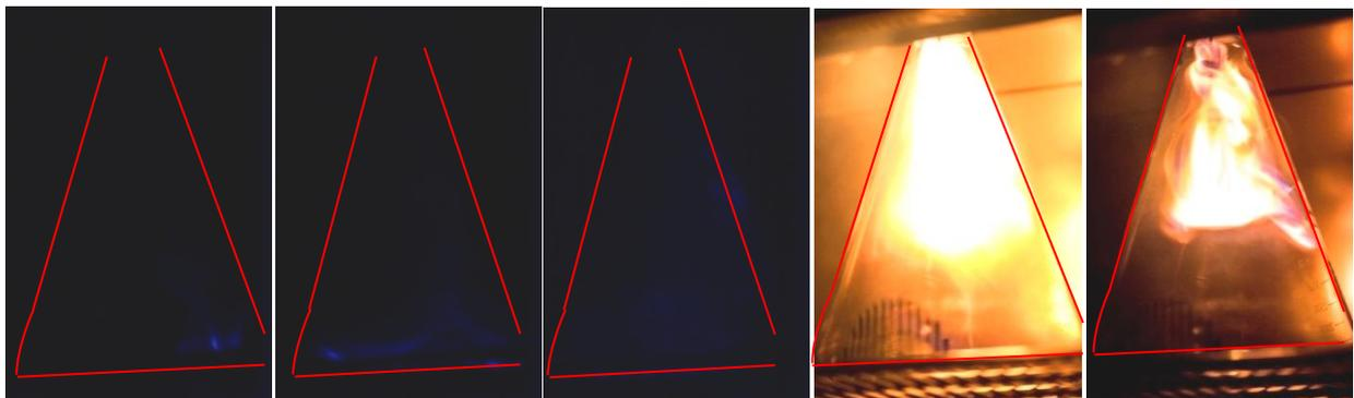
Abb. 9: Verlauf einer Zweistufenzündung (Cyclohexylacetat bei 294 °C)
