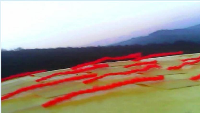
Abb. 19: Analyse der Strömungsverhältnisse am Außenflügel mithilfe von Wollfäden
