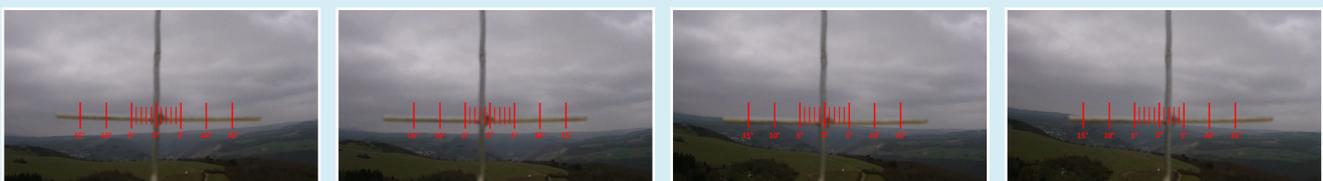
Abb. 14: Analyse der Dutch Roll Bewegungen: Ein Drahtkreuz wird mit einer Videokamera gefilmt und die Bilder für die Auswertung stabilisiert
