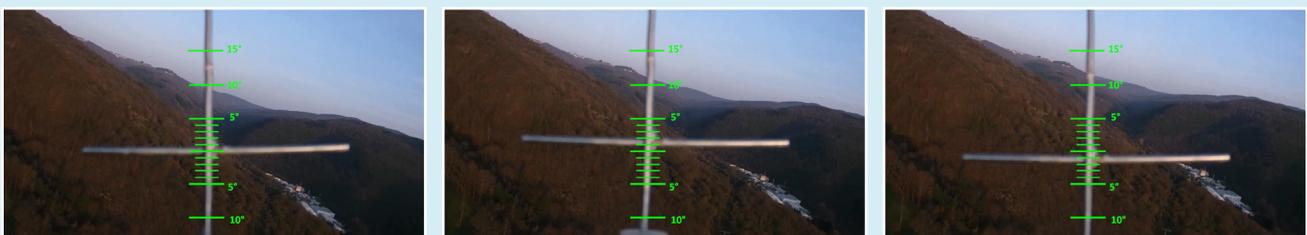
Abb. 11: Analyse der alpha-Schwingung: Ein Drahtkreuz wird mit einer Videokamera gefilmt und die Bilder für die Auswertung stabilisiert
