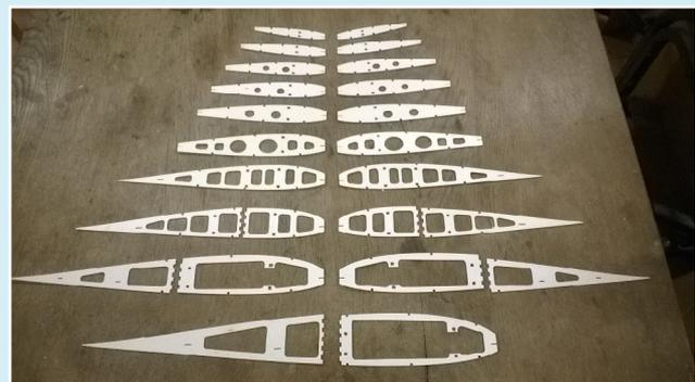
Abb. 7: Dokumentation des Druckvorgangs (links) und der fertigen Rippen (rechts)
