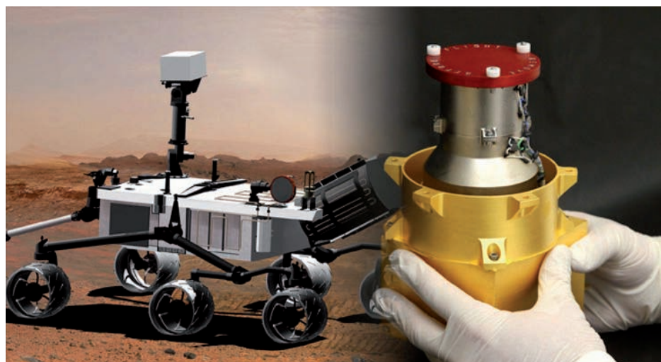
Bild 7: Auf dem Mars-Rover „Curiosity“ befindet sich der „Radiation Assessment Detector“ (RAD). Damit kann das Strahlungsfeld auf der Marsoberfläche untersucht werden. Quelle: NASA / JPL-Caltech / Sw
