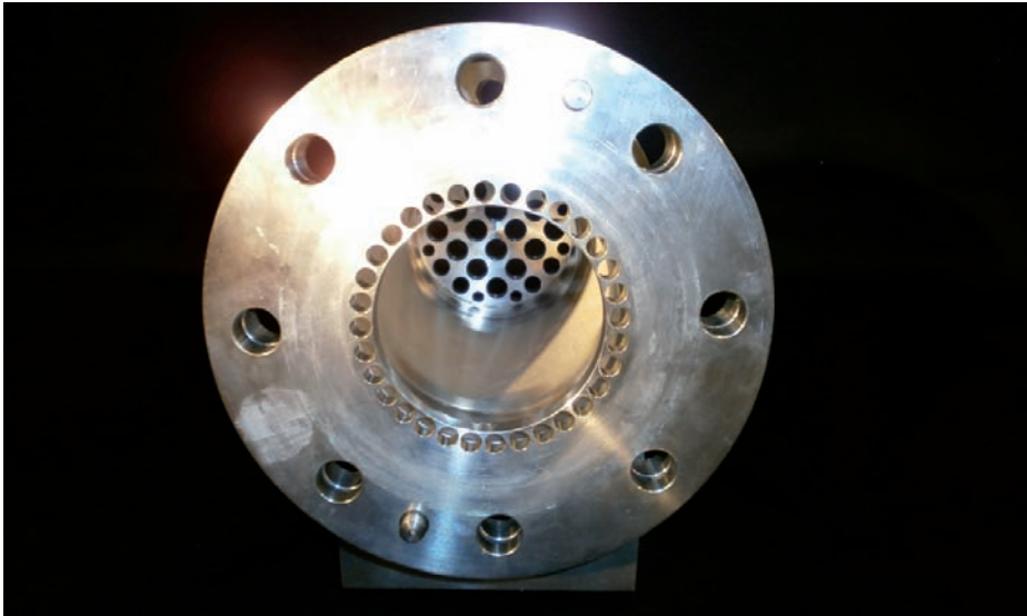
Bild 12: Strömungsgleichrichter als Kombination eines Lochkreises zur Anfachung der Turbulenz mit einem Zanker-Gleichrichter
