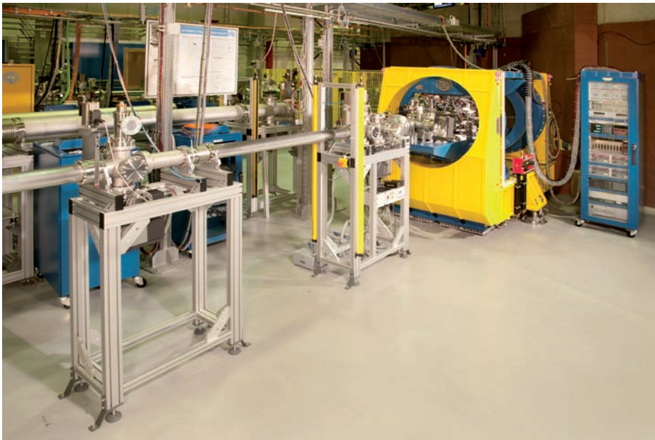
Bild 1: Messplatz für die Kalibrierung von Strahlungsquellen im Spektralbereich von UV- und Vakuum-UV-Strahlung an der MLS
