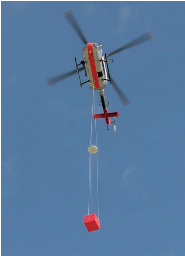
Bild 10: Referenzantenne (Mitte) und Empfangseinrichtung (roter Kasten), positioniert von einem Hubschrauber
