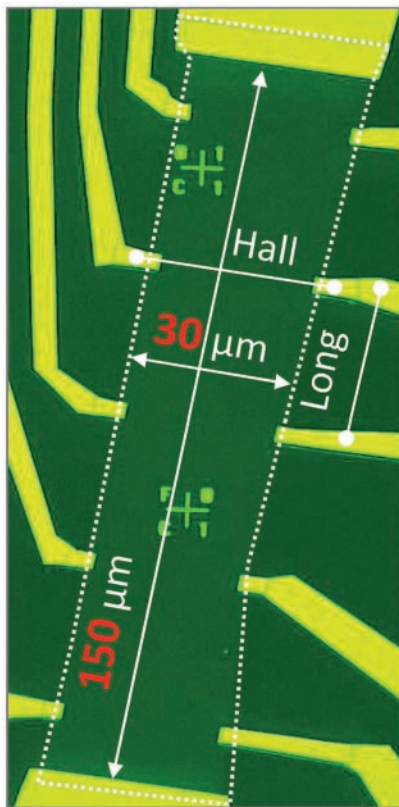
Bild 3: Quanten-Hall-Widerstand aus einem Graphenfilm auf einem Galliumarsenid-Wirtssubstrat
