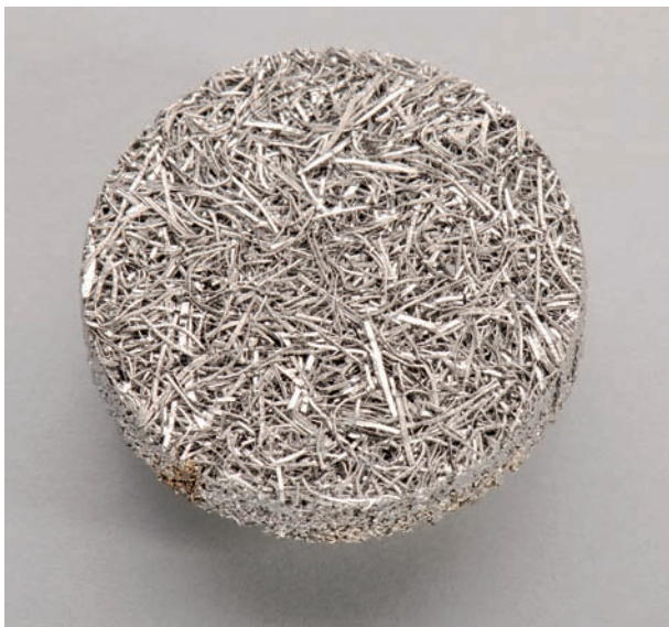
Bild 6: Ausführungsvariante eines permeablen Werkstoffes (gesinterte Kurzfasern)
