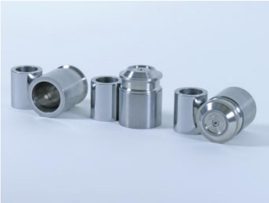
Bild 4: Kolben-Zylinder-Systeme für Absolutdruckmessungen mit einer Unsicherheit von 1 ppm
