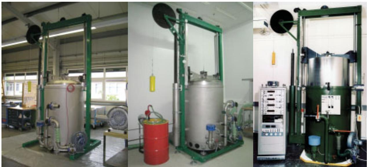
chen volumetrischen Normals zu verifizieren. Die festgestellten Differenzen zwischen den beiden Gasmessglocken, s. Bild 4, lagen deutlich innerhalb der Messunsicherheitsbudgets von jeweils 0,06 %.
