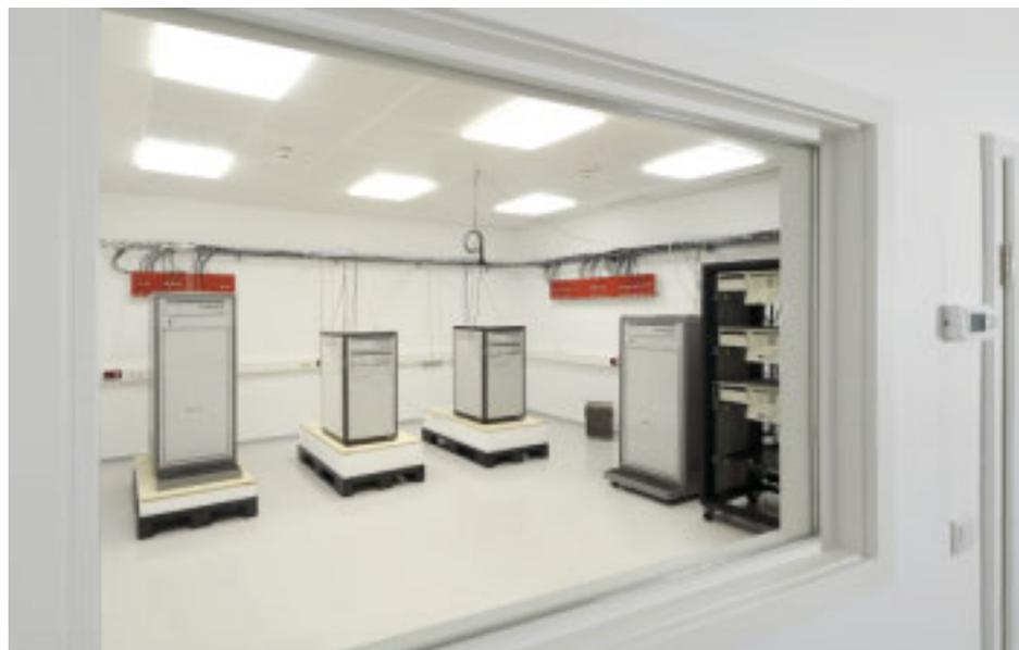
Bild 5: Blick auf die Wasserstoffmaser und kommerziellen Caesiumatomuhren der PTB in einem neuen Raum mit verbesserten Umgebungsbedingungen.
