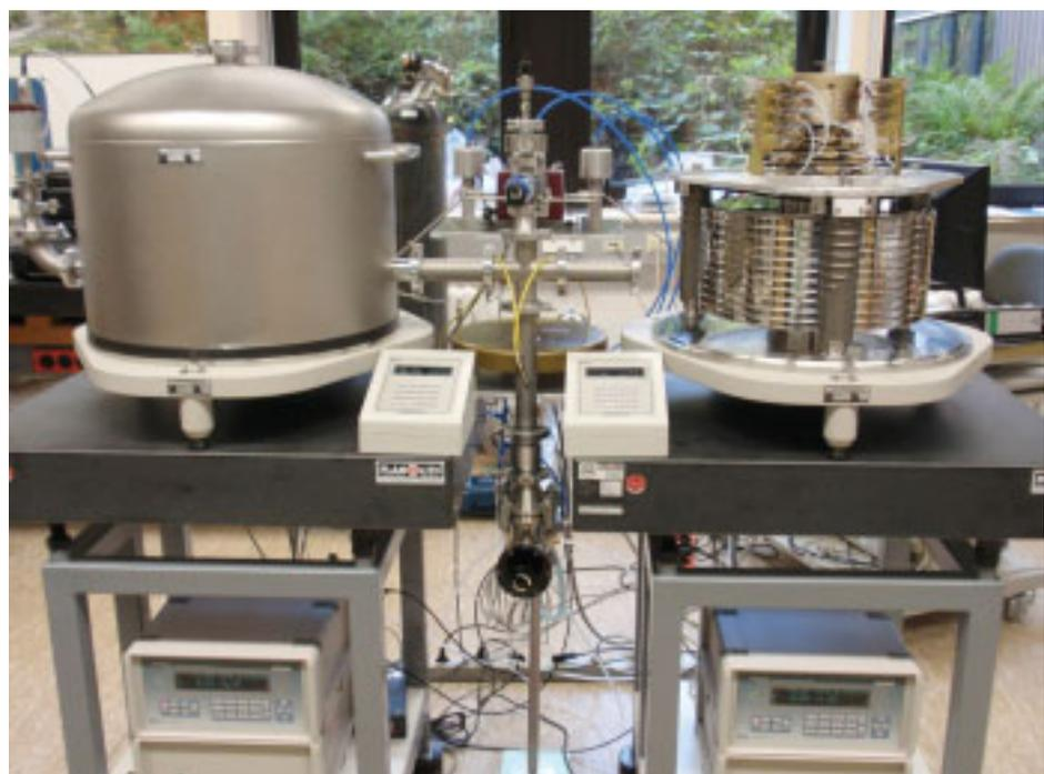
Bild 5: Kolbenmanometer zur Druckmessung für eine Neubestimmung der Boltzmann-Konstante
