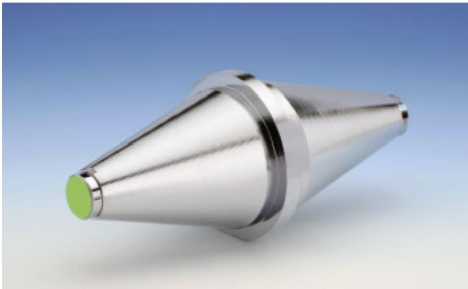
Bild 10: Resonator aus einkristallinen Silicium, bei dem auf den Endflächen des Abstandshalters optisch beschichtete Siliciumspiegel aufgebracht sind.
