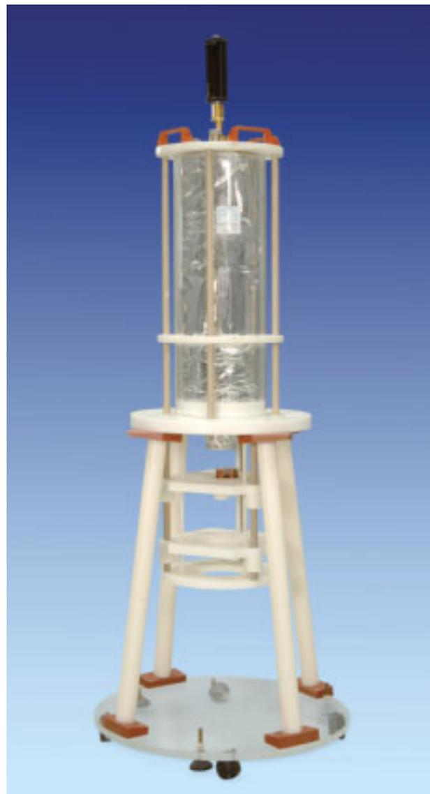
Bild 7: In der PTB entwickeltes SQUID-MRX-Spektrometer
