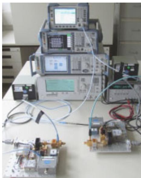
Bild 7: Sende- und Empfangsmodul eines Messsystems zur Charakterisierung von Übertragungskanälen zukünftiger Terahertz-Kommunikationssysteme.
