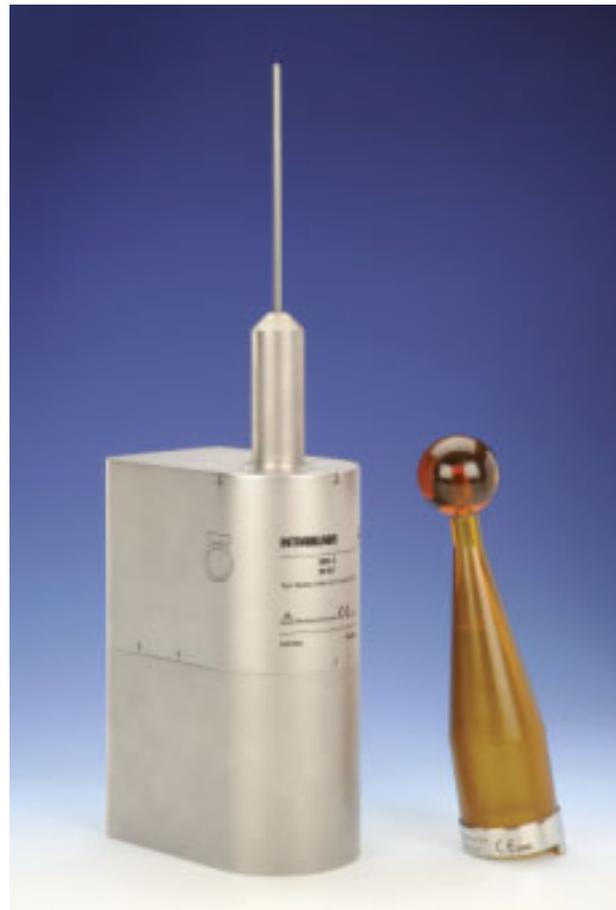
Bild 2: Miniatur-Röntgenquelle (links) mit sphärischem Applikator (rechts) zur gezielten Positionierung im Tumorbett.
