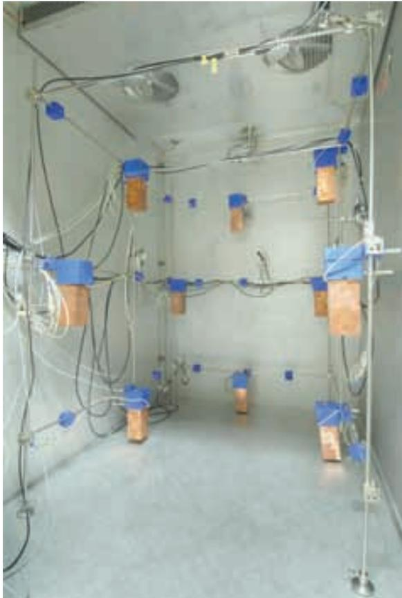
Bild 7: Thoron-Folgeprodukt-Kammer mit Quellkontrollsystem, Luftmonitorsystem und Messfühler zur Überwachung der Umweltparameter.
