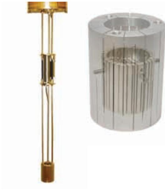
Bild 11: Zweite Kernentmagnetisierungskühlstufe aus reinem Platin für die Kühlung auf Temperaturen nahe 1  $\mu$ K.
