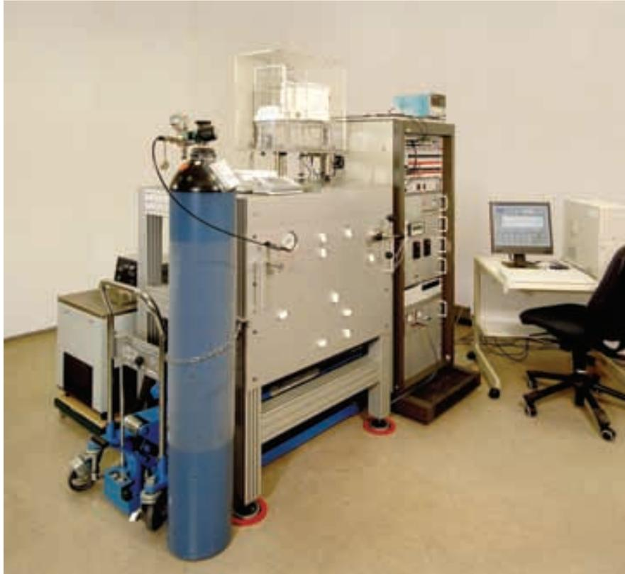
Bild 3: Ansicht der erweiterten Normdichteapparat mit Komparatorwaage, Bedienfront und Messelektronik.
