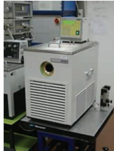
Bild 3: Detektorcharakterisierung bei zwei verschiedenen Strahlertemperaturen; Hohlraumstrahler für Terahertz-Strahlung im Einschub.
