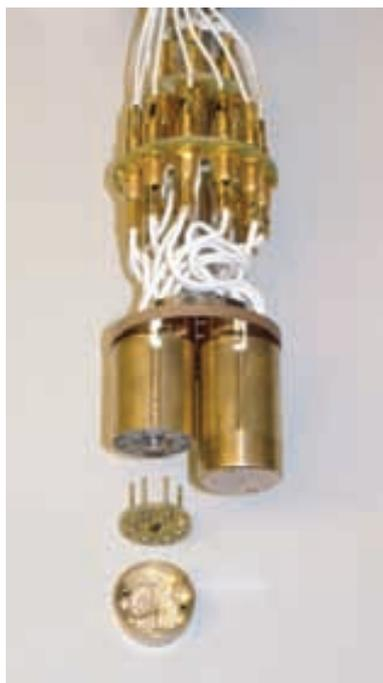
Bild 2: Doppelprobenhalter für zwei Quanten-Hall-Widerstände zum Einsatz in einer Quadraturbrücke
