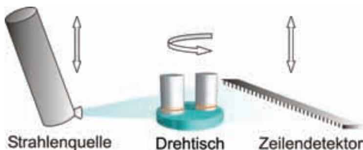
Bild 1: oben: Prinzip 3D-CT mit Kegelstrahl und Flachdetektor, unten: Prinzip 2D-CT mit Fächerstrahl und Zeilendetektor
