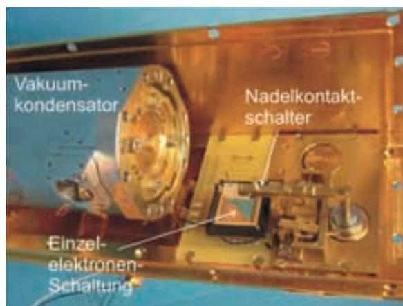
Bild 3: Tieftemperatur-Messeinheit des ECCS-Experiments
