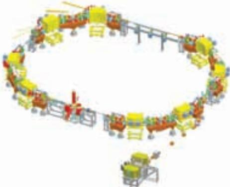
Layout des MLS-Speicherrings mit einem Mikrotron (unten rechts) als Injektor
