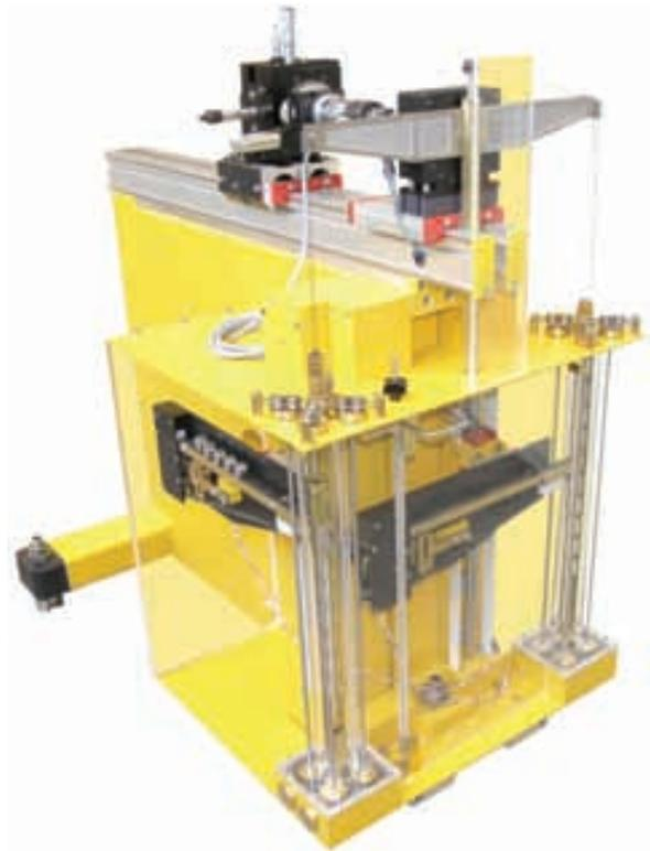
Bild 3: Die neue 1-N·m-Drehmoment-Normalmesseinrichtung der PTB
