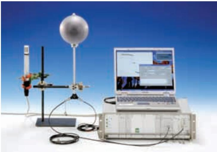
Bild 5: Mobiles Messsystem zur zeitaufgelösten Messung gepulster Strahlung mit einer Kugelsonisationskammer.
