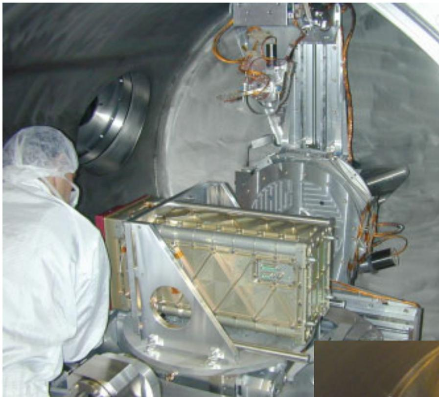
Bild 9: Solarspektrometer SOL-ACES für das europäische COLUMBUS-Modul der internationalen Raumstation ISS im geöffneten Tank des EUV-Reflektometers bei BESSY II
