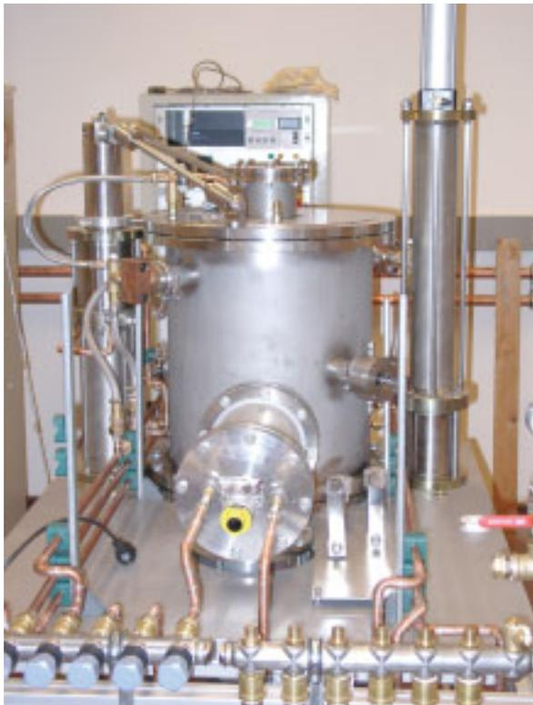
Bild 5: Isothermer Hochtemperatur-Thermostat zur Entwicklung von eutektischen Fixpunktzellen
