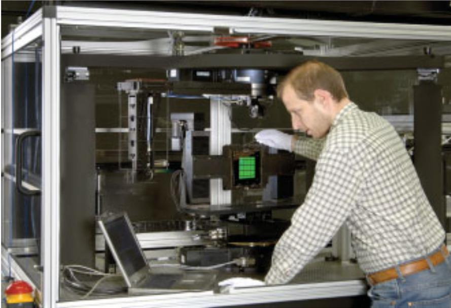
Bild 5: Das neue Deep UV-Scatterometer der PTB.
