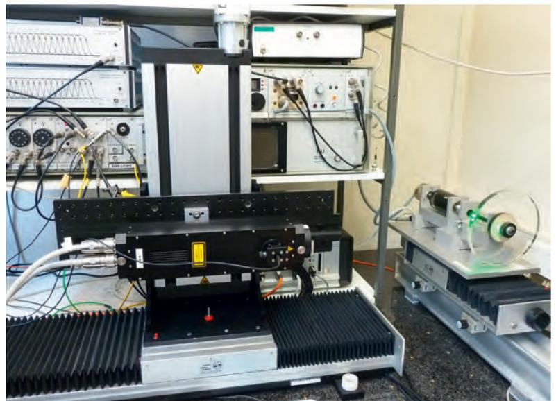
Mit diesem Primärnormal werden auf der zweiten Stufe der Kalibrierkette Laser-Doppler-Anemometer (LDA) kalibriert, die dann entweder direkt als kalibriertes Messgerät für die berührungslose Strömungsgeschwindigkeitsmessung oder als Bezugsnorm (Referenz) in Windkanälen zur Kalibrierung von Strömungssensoren wie Staudrucksonden, Hitzdraht- oder Flügelrad-Anemometern zum Einsatz kommen.
