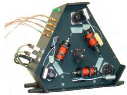
Zu sehen ist der Messkopf des Drei-Komponenten-LDA. Der Lasermessstrahl ist mittig angeordnet; die Beobachtungsstrahlen sind symmetrisch in den Ecken positionierbar angeordnet.
