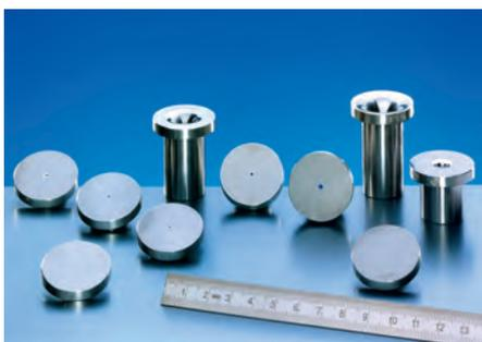
Venturidüsen für die Erzeugung kleinerer Durchflüsse
