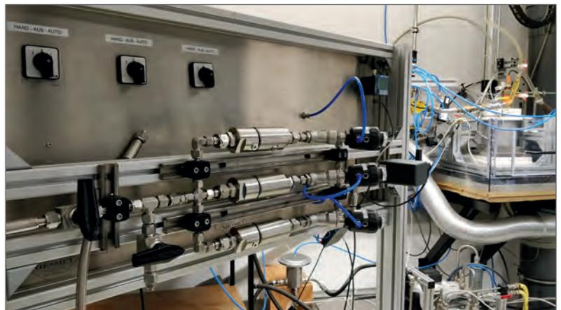
Bild 5: Kavitationsdüsenapparatur „Little Boy“ mit 3 parallel betriebenen Kavitationsdüsen
