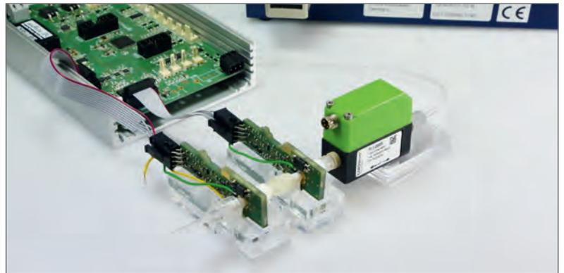
Bild 5: Einwegsensoren zur kapazitiven Durchflussmessung in Schläuchen. **Vorn:** Einwegsensoren mit beiden Messstellen und dazwischenliegender Drossel, **Rechts:** Referenzsensor, **Links:** Elektronik [10]
