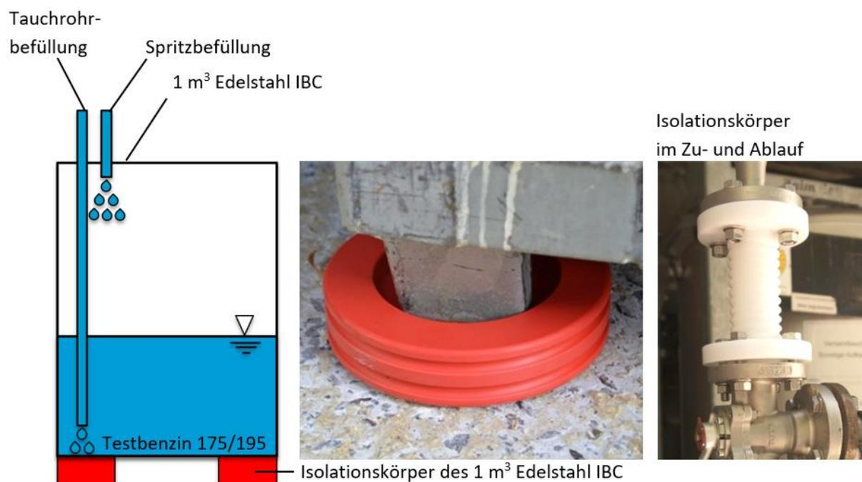
Abbildung 2: Isolatorkörper des 1 m<sup>3</sup> Edelstahl IBC
