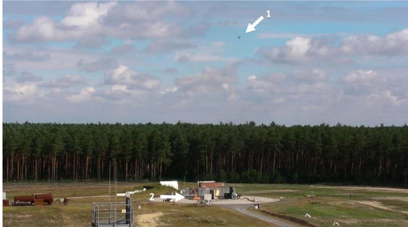
Abbildung 7: "Frisbeeing" eines Fragments, Nr. 1 das Fragment, Nr. 2 Unterfeuerung bzw. Ort des Behälterversagens.
