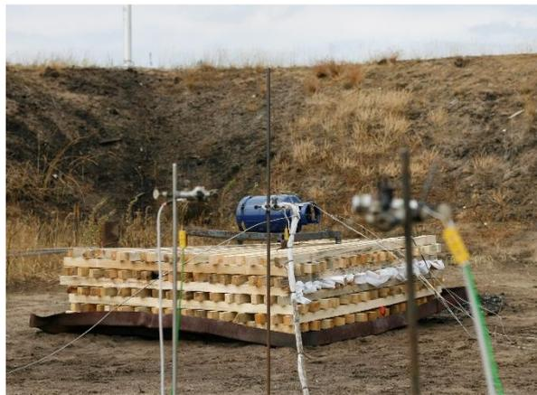
Abbildung 3: Genereller Aufbau der Unterfeuerungsversuche, im Hintergrund eine 11-kg-Propangasflasche mit einem vorbereiteten Holzfeuer (Versuchsserie 1, vgl. Tabelle 2), im Vordergrund 3 Stative mit Druck- und Temperatursensoren für die Messung der Wirkung des Behälterversagens auf die Umgebung.
