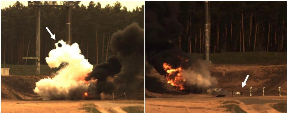
Abbildung 6: "Rocketing" von Fragmenten, Radmuldentanks, FG 100 %, angetrieben durch verdampfendes und freigesetztes Flüssiggas.
