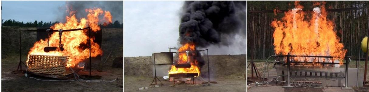
Abbildung 1: Quantifizierung verschiedener Unterfeuerungsmethoden, Holzfeuer (links), Benzinpoolfeuer (mittig), Gasfeuer (rechts), je mittig hängend im Feuer der wasserdurchströmte Flaschendummy.
