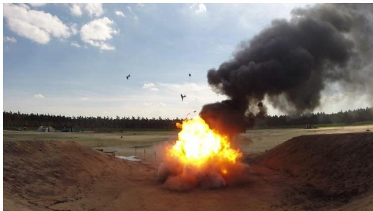
Abbildung 5: Fragmentierung direkt nach Behälterversagen, Radmuldentank, Füllgrad 20 %.
