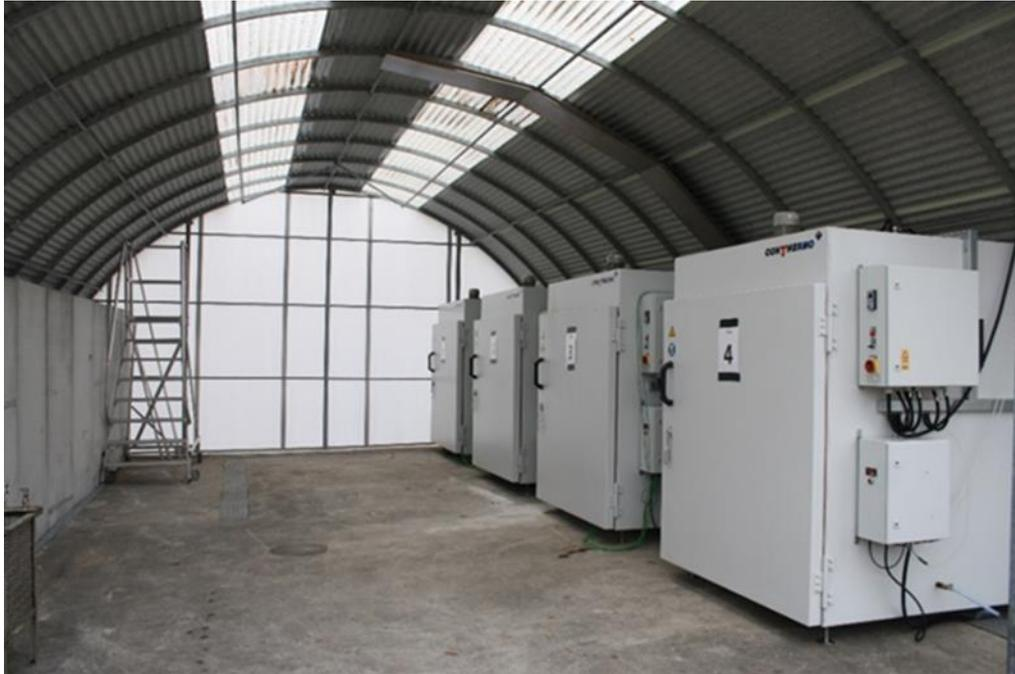
Abbildung 2: Wetterschutztunnel mit 4 Versuchsöfen (Wärmekammern)
