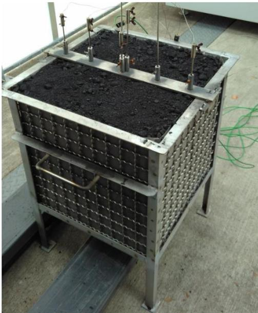
Abbildung 3: Instrumentierter Probenbehälter (125 dm<sup>3</sup>) mit Koksprobe
