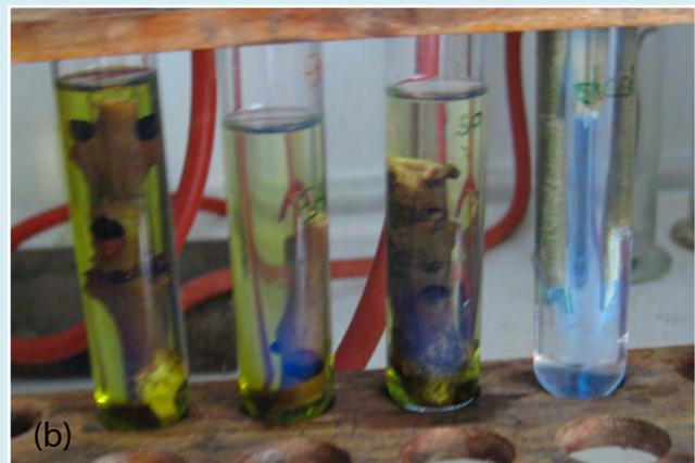
Abb. 3b: Fraxinextraktion (von links nach rechts) in Aceton, Ethanol, Isopropanol und dest. Wasser unter UV-Licht mit einer Wellenlänge von 366 nm
