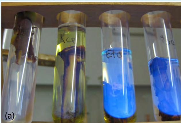
Abb. 3a: Aesculinextraktion (von links nach rechts) in dest. Wasser, Aceton, Ethanol und Isopropanol unter UV-Licht mit einer Wellenlänge von 366 nm
