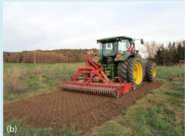
Abb. 4: Versuchsfläche B auf der ehemaligen Deponie a) Abgesteckte Fläche b) Bearbeitung mit dem Zinkenrotor)
