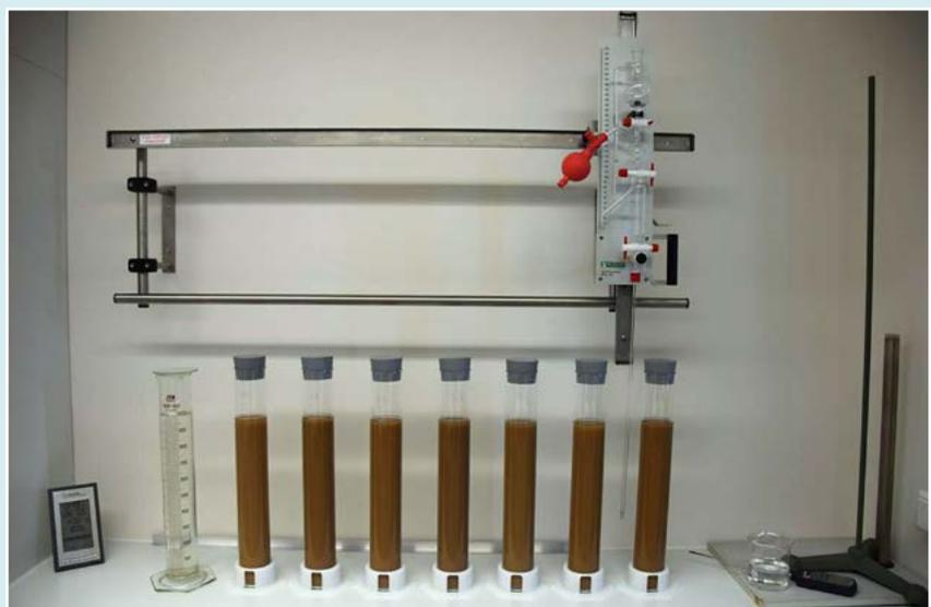
Abb. 3: Versuchsaufbau zur Bestimmung der Korngrößenfraktion < 0,063 mm mittels Pipettverfahren nach Köhn
