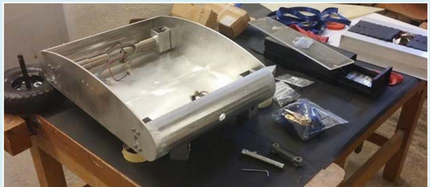
Abb. 2: Grundplatte, Seitenteile und vordere und hinter Verschalung nach dem Zusammenbau (Bild: D. Henniger)
