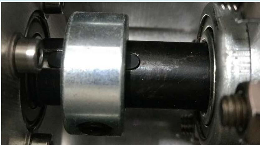
Abb. 5: Klemmring und Feder-Nut-Verbindung
