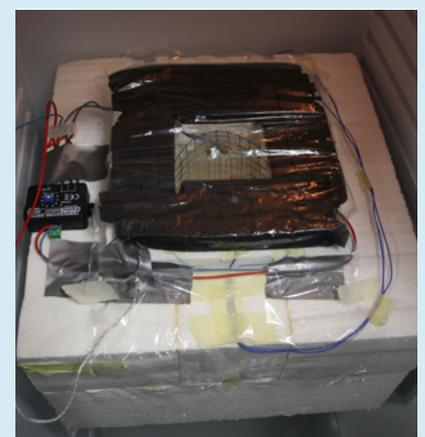
Abb. 2: Polystyrol-Kubus zur Bestimmung des wärmeleitenden Verhaltens
