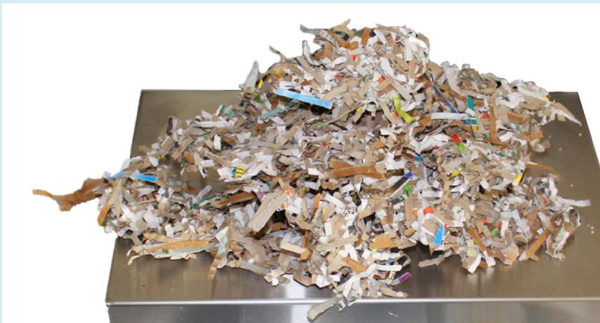
Abb. 1: Erster Prototyp – eine getrocknete Mischung aus Altpapierschnipseln und Wasser
