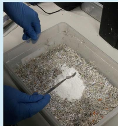
Abb. 5: Die Rohmasse von recypap, der Altpapierschnitt, wird mit Magnesiumhydroxid vermengt
