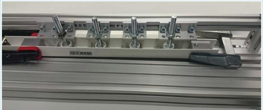
Abb. 6: Gussform für die Silikonschicht
