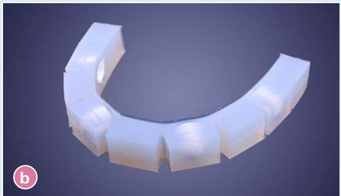
Abb. 7: a) Eingegossenes Silikon und b) herausgenommene Silikonschicht, die durch Biegefugen eine hohe Flexibilität aufweist
