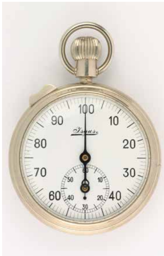
Bild 5: Stoppuhr mit Dezimalskala für 1/100-Minuten, ISGUS, Schwenningen, um 1920 [Deutsches Uhrenmuseum Furtwangen, K-0747]
