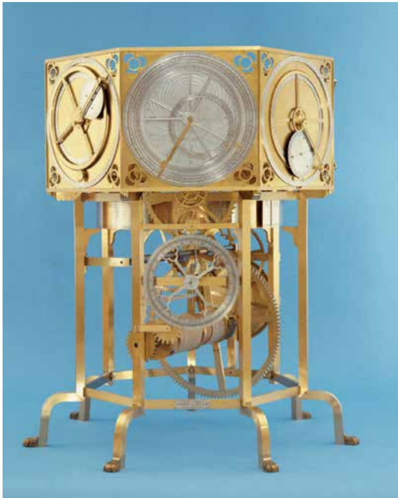
Bild. 1: Nachbau des Astrariums, einer astronomischen Uhr mit Darstellung der Planetenbewegungen von Giovanni Dondi, 1364 [Musée International D'Horlogerie, La-Chaux-de-Fonds]
