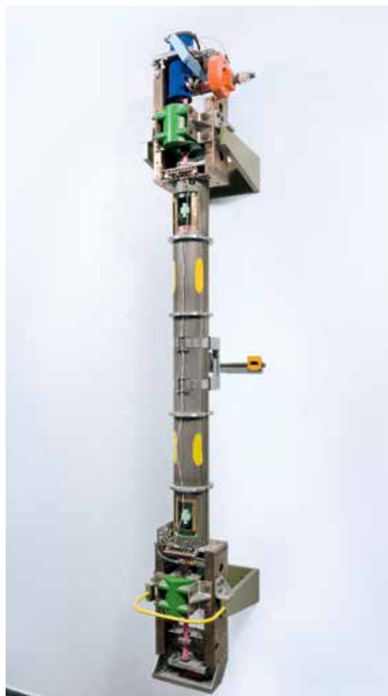
Bild 1: Das Strahlrohr des Atomichrons der PTB, welches Mitte der sechziger Jahre benutzt wurde, um die Gänge der Quarzuhren in Braunschweig und in Mainflingen zu kontrollieren. Einige Elemente sind farbig markiert, so die magnetische Abschirmung (gelb), der Detektor (blau) und die Ablenkmodule (grün). Die Abschirmung ist aufgeschnitten und so sieht man die beiden Endstücke des Ramsey-Resonators (hellgrün). Der Atomstrahl verläuft teilweise in einem dünnen Metallrohr (rosa).
