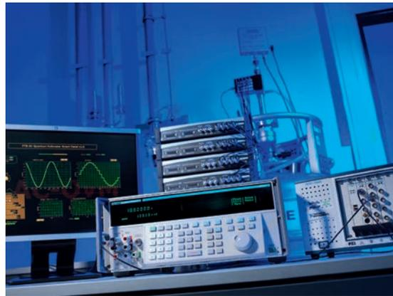
Bild 7: Ein kommerzieller Präzisions-Kalibrator (Bildmitte) wird durch den PTB-AC-Quantenvoltmeter-Laboraufbau im Wechselspannungsmodus kalibriert; Ergebnis des europäischen iMERA-plus-Projektes JOSY.
