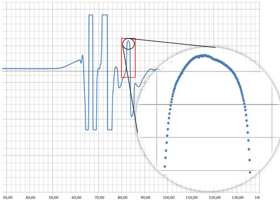
**Abbildung 4:** Vergrößerte Darstellung eines Peaks im Signalverlauf von Sensor 1. Aufgrund der hohen Messpunktdichte verschmelzen diese in der grafischen Darstellung, stehen aber natürlich für die mathematische Auswertung sauber getrennt und in großer Anzahl zu Verfügung.
