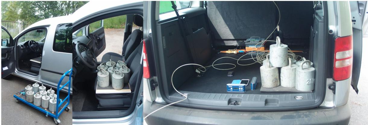
*Bild A1: Der „kräftige Messbeamte“ wird durch sieben Massestücke zu je 20 kg simuliert und nimmt an verschiedenen Stellen im Fahrzeug Platz. Im rechten Bild sieht man neben dem „Messbeamten“ das Handy mit der Wasserwaagen-App sowie die zwei digitalen Wasserwaagen. Die Batterie und das Kabel im Hintergrund dienen der Versorgung des Präzisions-Winkelmesssystems.*
