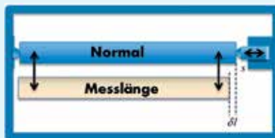
Bild 19: Prinzip der mechanischen Unterschiedsmessungen von Parallelendmaßen
