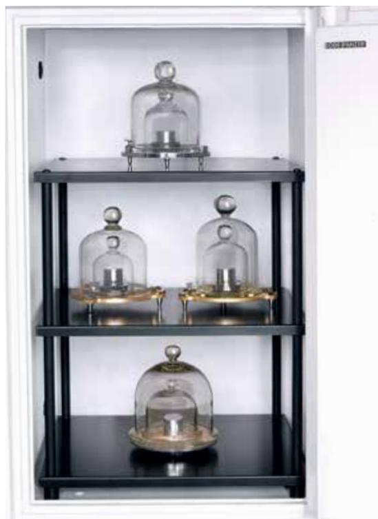
Bild 5: Sicher verwahrt: Die PTB besitzt mehrere kg-Prototypen, so die beiden Stücke, die an die Bundesrepublik Deutschland (#52, obere Ebene im Safe) und die DDR (#55, Mitte links) Anfang der 1950er Jahre ausgegeben wurden, sowie einen weiteren Prototypen (#70, Mitte rechts), den die Bundesrepublik 1987 erworben hat. Das Kilogramm mit der Nummer 22 (untere Ebene im Safe) stammt aus dem Jahr 1889, wurde im Krieg beschädigt und ist kein offizieller Prototyp mehr.
